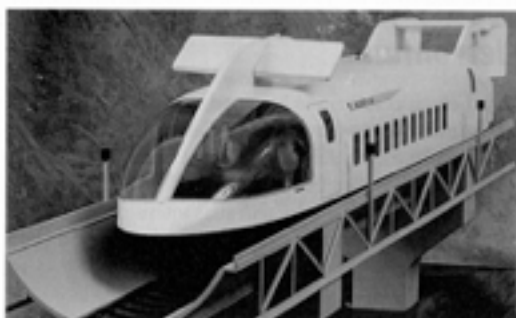
FIGURA 24.11 Um modelo em escala de um veículo levantado magneticamente – um “magplane”. Enquanto os trens convencionais vibram ao percorrerem os trilhos em velocidades altas, nos “magplanes” pode-se viajar livre das vibrações, por não haver qualquer contato físico do veículo com a calha acima da qual flutuam enquanto se movem.
