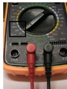
Figura 2b: Foto de parte do seletor de um multímetro digital. Nela é possível ver as duas pontas de prova encaixadas, a preta está no “COM” à direita e a vermelha no conector “mA” à esquerda. O seletor na figura está apontando para a indicação 2m. Na região circulada pelo quadrado preto temos as escalas usadas para a medição da corrente elétrica.
