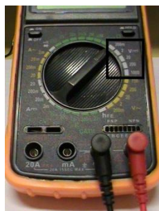
Figura 4: Foto de parte do seletor de um multímetro digital. Nela foi usado um quadrado preto para marcar a região em que o seletor deverá ser colocado para medir a voltagem das 4 pilhas de 1,5V presentes no suporte.
