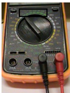
Figura 3: Foto de parte do seletor de um multímetro digital. Nela foi usado um retângulo preto para marcar a região em que o seletor deverá ser colocado a fim de medir a resistência elétrica da lâmpada.
