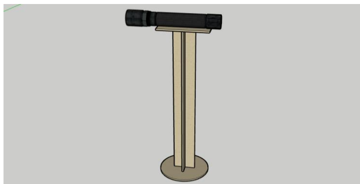
Figura A46: Peças 43, 44, 45, 46 e 47 após serem coladas para montar o suporte da lanterna.
