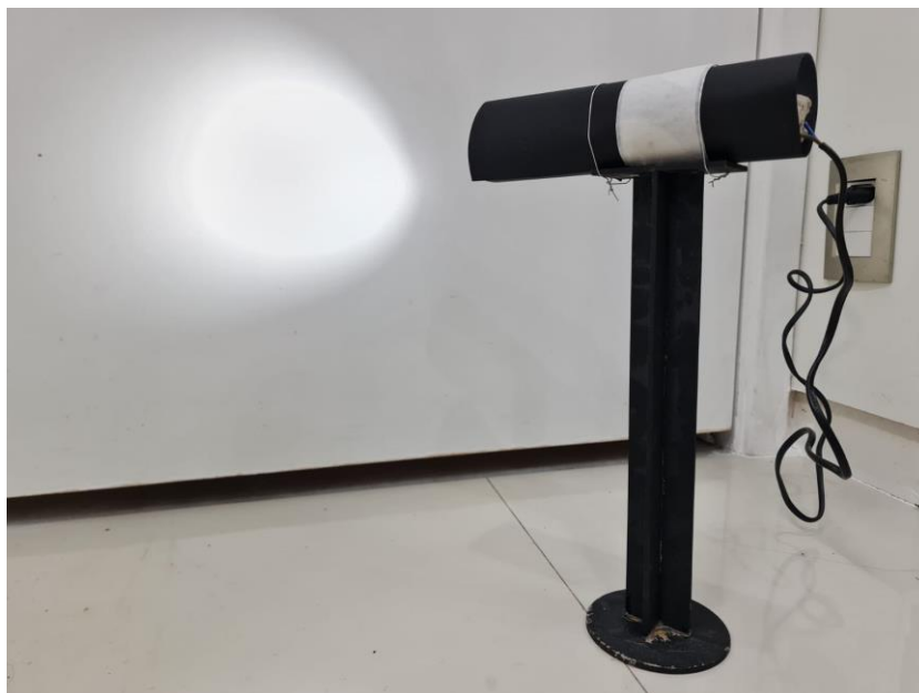
Figura A47: Sugestão de adaptação de lâmpada residencial de LED de 5W com tubo de papel preto colado com fita.
