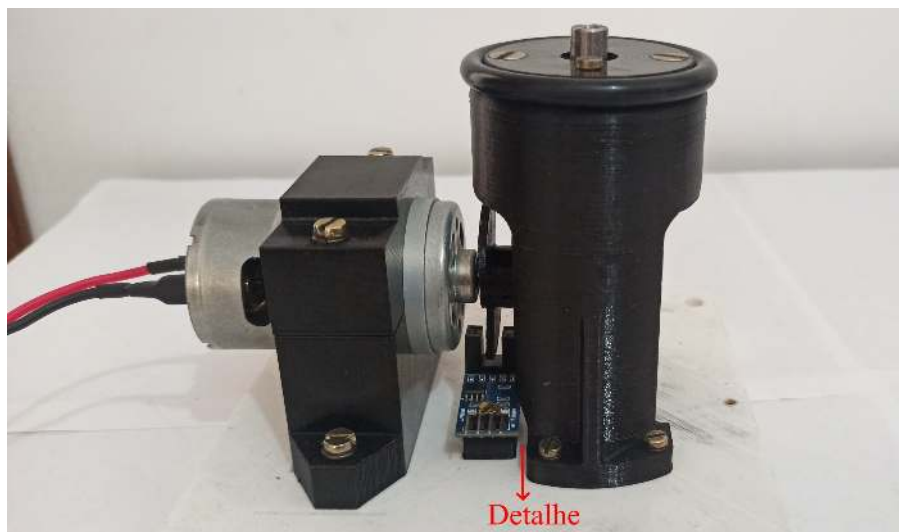
Figura 5.16: Montagem da carcaça porta rolamento na base geral. O detalhe na carcaça porta rolamento é um corte que foi feito na peça que demarca o lado que ela tem que ser montada. Não é possível montá-la utilizando o outro lado, pois a carcaça bate no sensor.
