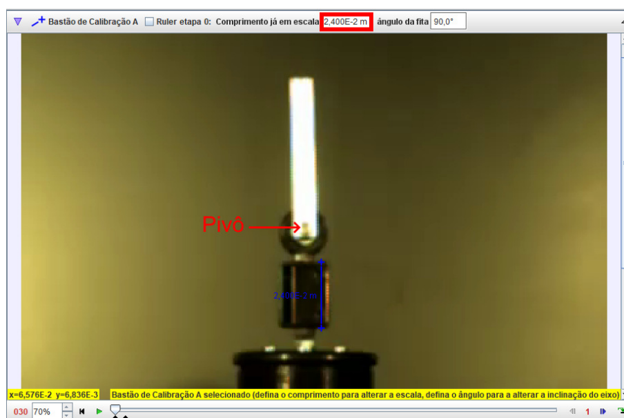
Figura 3.6: A seta vermelha indica onde fica localizado o pivô. A linha vertical azul é o “Bastão de Medição” usado na análise de vídeo do experimento Pêndulo de Kapitza. Na parte superior, o retângulo vermelho destaca o campo “comprimento já em escala”.
