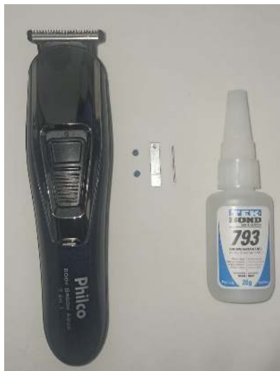
Figura 2.1: Material necessário para montar o experimento Pêndulo de Kapitza de baixo custo.
