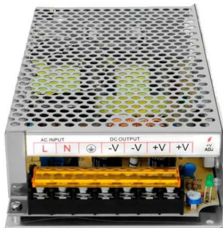
Figura 5.24: Modelo da fonte AC/DC 12 V recomendada.
