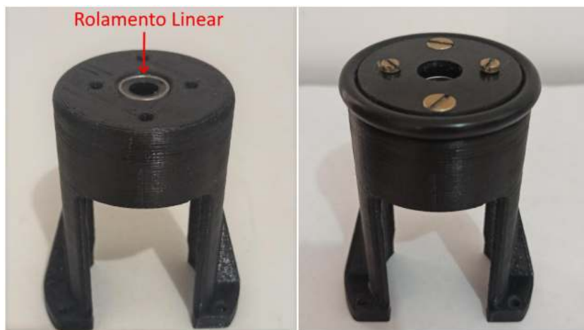
Figura 5.13: Montagem do rolamento linear, tampa para rolamento linear e do anel o’ring (anel de borracha) na carcaça porta rolamento.
