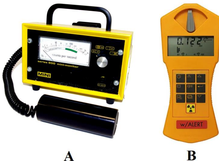
Figura 20: Contadores/detectores Geiger. A imagem A mostra um aparelho Geiger convencional utilizado na indústria. A imagem B é uma versão portátil do contador Geiger.
