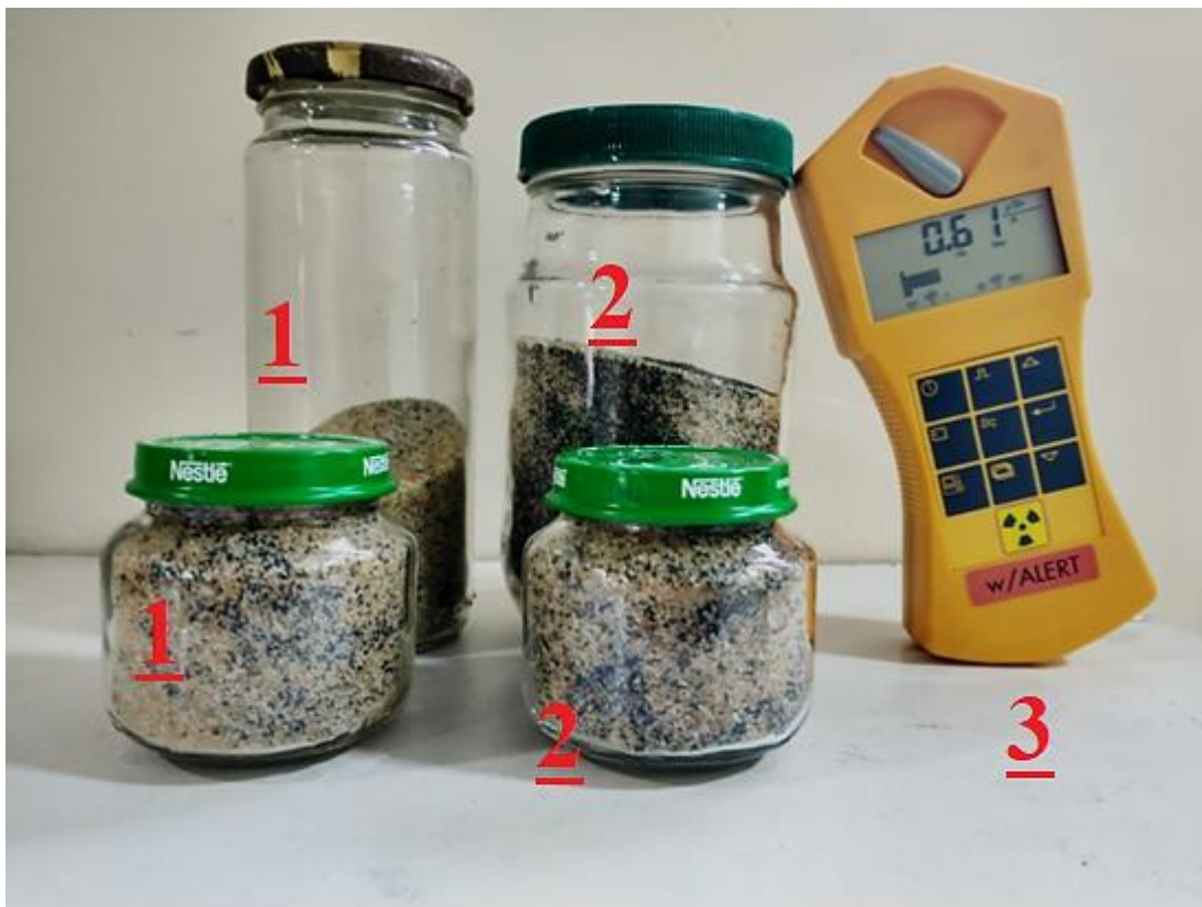
Figura 11. Potes contendo areia simples (1), areia monazítica (2) e contador Geiger (3); todos os materiais utilizados nas atividades experimentais.
