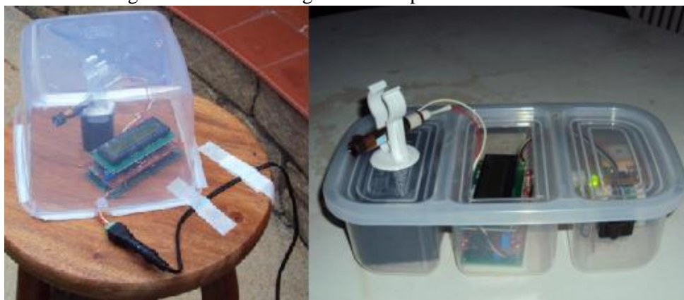
Figura 23 – Montagem do contador Geiger com componentes eletrônicos e tubo de Geiger.
