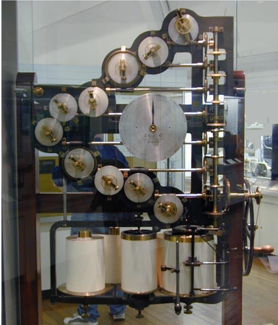
Figura 22. Máquina de previsão de marés de 10 componentes de 1872-3, concebida por Sir William Thomson (Lord Kelvin) e projetada por Thomson e colaboradores, no Science Museum, South Kensington, Londres. Disponível em: https://upload.wikimedia.org/wikipedia/commons/d/d7/DSCN1739-thomson-tide-machine.jpg . Acesso em 24/04/2023.
