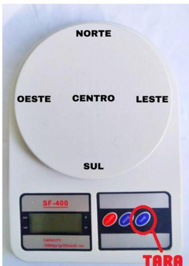
Figura 3.1 - Balança utilizada mostrando o botão tara e posições onde o recipiente foi colocado sobre a balança. As palavras Norte, Sul, Leste, Oeste e Centro presentes na imagem não são originalmente da balança.
