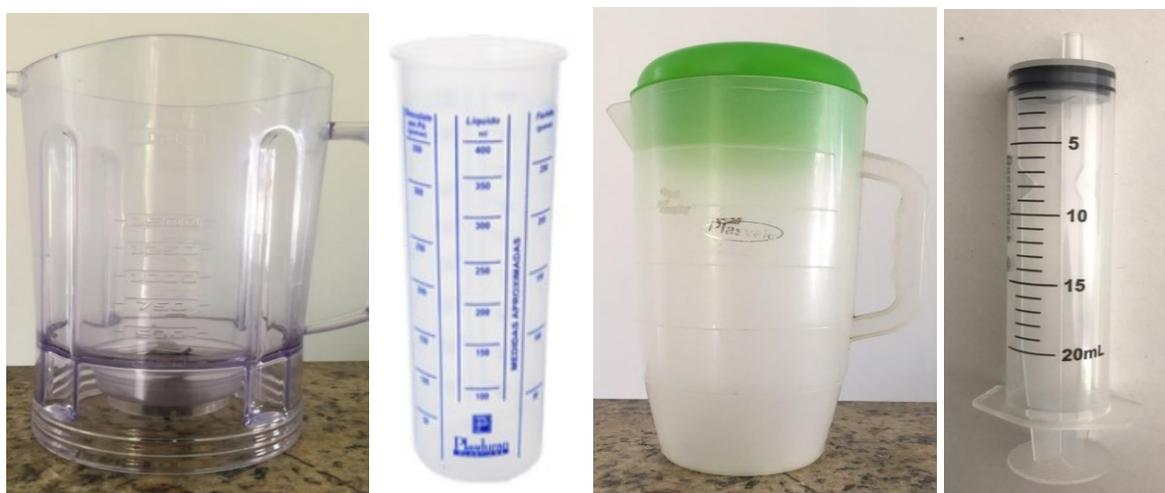
Figura 3.6 - Recipientes utilizados para gerar medidas de massa aumentando o volume com água: da esquerda para a direita: copo de liquidificador, copo medidor, jarra de suco e seringa.
