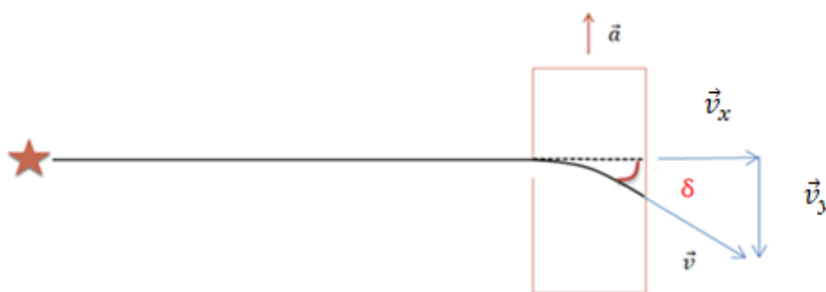
Figura A.1. O esquema de um raio de luz que sofre um desvio ao atravessar um elevador de largura igual ao diâmetro do Sol e as componentes da velocidade v .
