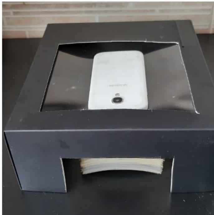
**Figura 4:** medidor da intensidade luminosa de placas transparentes.
