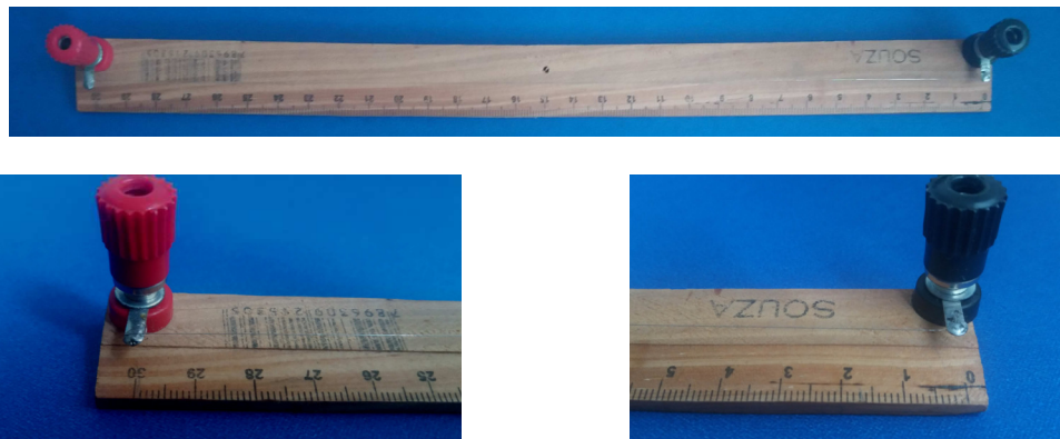
Figura 3.9: Resistor variável com fio de níquel cromo.
