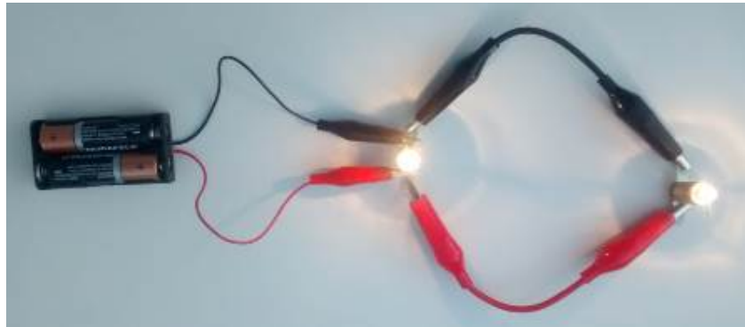
Figura 4.3: Circuito com duas lâmpadas idênticas em paralelo
