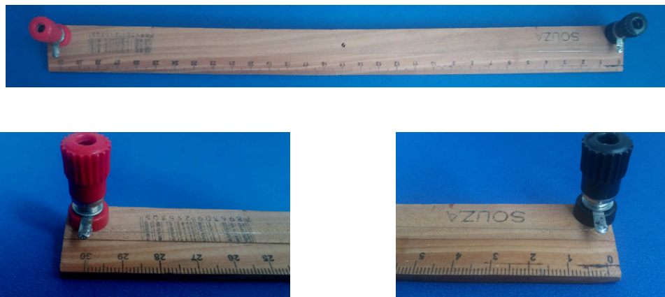
Figura 4: Resistor variável com fio de níquel cromo.
