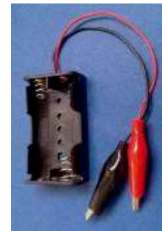
Figura 3.2: Detalhe de um suporte de pilhas
