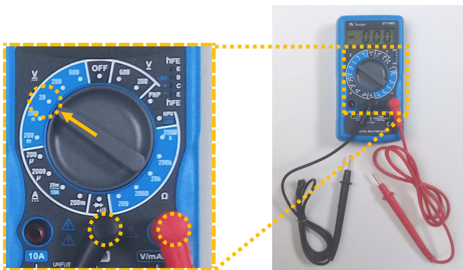
Figura 6.2: Detalhe do multímetro ajustado como voltímetro
