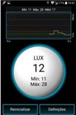
Será preciso um smartphone de sistema *Android* que possua um sensor de luz ambiente com um aplicativo de luxímetro instalado. Utilizamos este da foto que tem o nome de Luxímetro e pode ser encontrado gratuitamente na *Play Store* da *Google*. O interessante seria a utilização do smartphone de um aluno de cada grupo, caso
