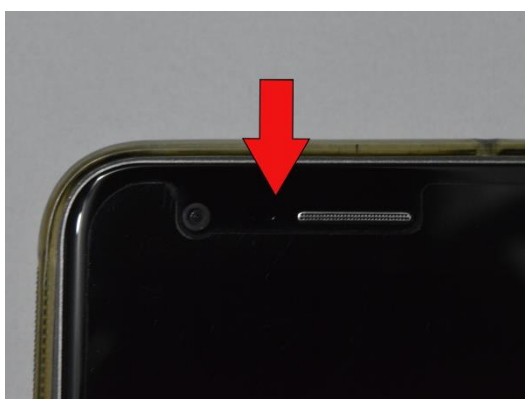
Figura 4.5: Destaque da localização do sensor de luz ambiente no smartphone LG K10 2017.
