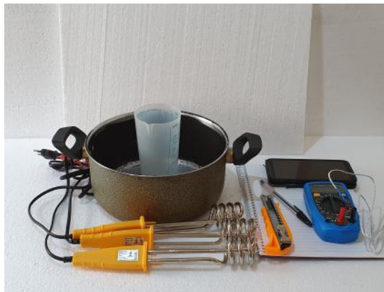
Figura 1. – Materiais empregados nas atividades: panela de metal; placas de isopor; cortador de isopor; três ebulidores; termômetro digital; e lápis e papel.
