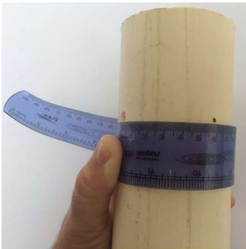
Figura 3.46 – 2ª Marcação para execução da abertura lateral no tubo PVC 75 mm. Fonte: O Autor.
