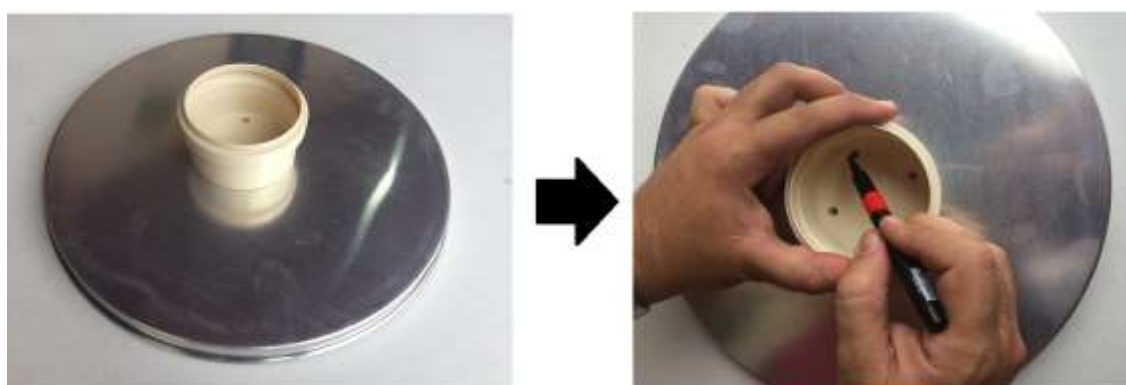
Figura 3.70 – Marcações para a execução dos furos na forma de pizza. Fonte: O Autor.
