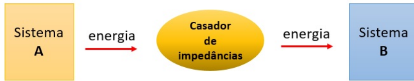
Figura 3: Para sistemas A e B de impedâncias descasadas, um casador de impedâncias colocado entre eles aumenta a transferência de energia.
