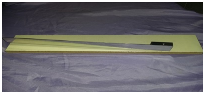
Figura 22: O casador de impedâncias construído com uma alavanca. Usamos uma barra de alumínio com um encaixe do mesmo material em uma de suas extremidades, por onde passa o eixo de rotação. O conjunto foi fixado a um pedaço de madeira.
