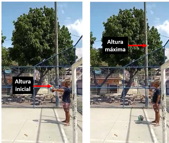
Figura 19: Queda de duas bolas, uma de tênis e outra de basquete. As imagens do vídeo mostram que a altura máxima atingida pela bola de tênis após o quique é cerca de três vezes maior que sua altura inicial.
