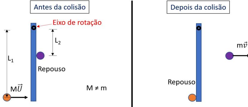
Figura 3.21: Casamento de impedâncias com uma alavanca. O diagrama à esquerda mostra o sistema projétil-alavanca-alvo antes da colisão. À direita vemos o sistema após a colisão.
