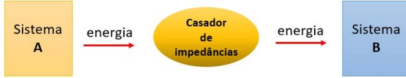
Figura 3.3: Para sistemas  $A$  e  $B$  de impedâncias descasadas, um casador de impedâncias colocado entre eles aumenta a transferência de energia.
