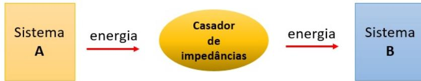
Figura 3: Para sistemas  $A$  e  $B$  de impedâncias descasadas, um casador de impedâncias colocado entre eles aumenta a transferência de energia.
