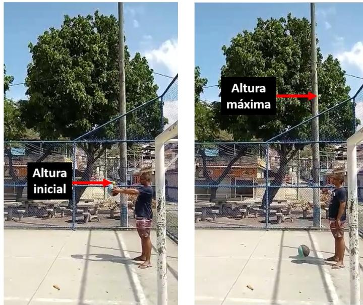
Figura 3.19: Queda de duas bolas, uma de tênis e outra de basquete. As imagens do vídeo mostram que a altura máxima atingida pela bola de tênis após o quique é cerca de três vezes maior que sua altura inicial.
