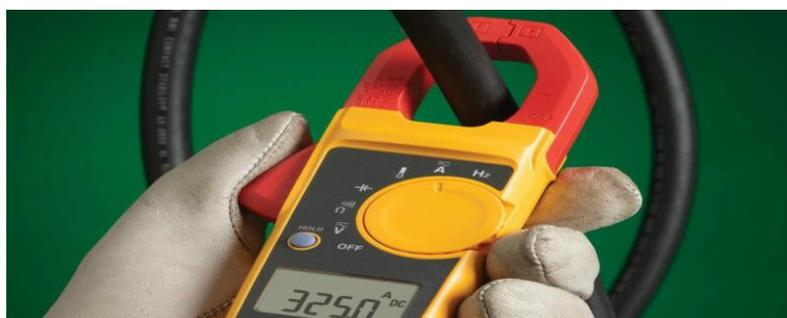
**Figura 6** - Medição de corrente alternada utilizando o alicate amperímetro.
