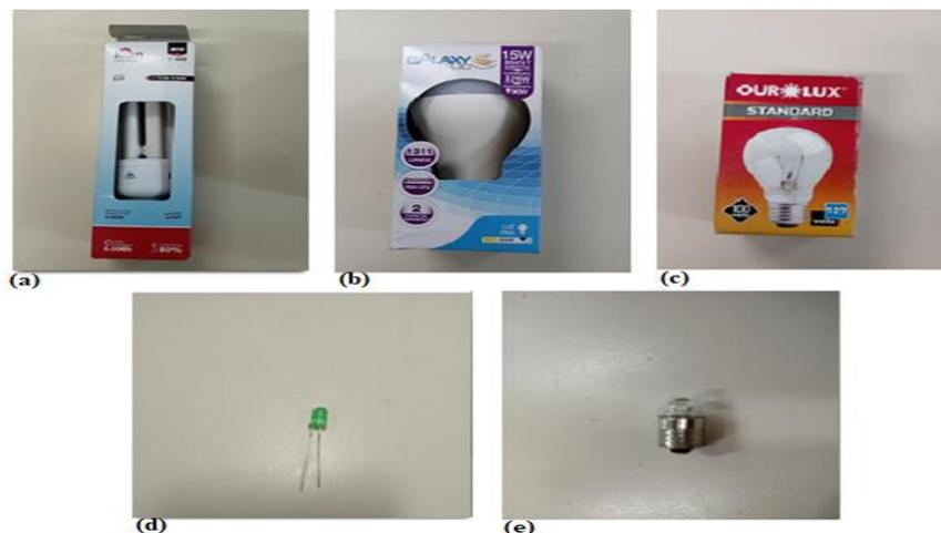
**Figura 1** - Materiais necessários para a terceira atividade: (a) lâmpada fluorescente, (b) lâmpada LED, (c) lâmpada incandescente, (d) LED, (e) lâmpada incandescente pingo d'água.
