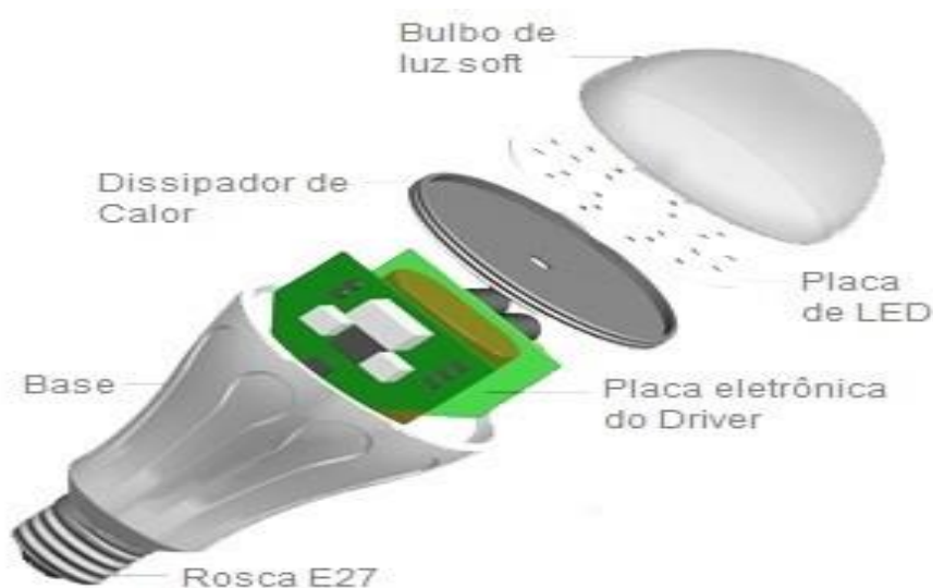
Figura 36 - Partes da lâmpada LED.
