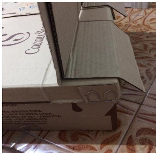
Figura 21 - Tampa refletora sendo fixada na tampa do forno
