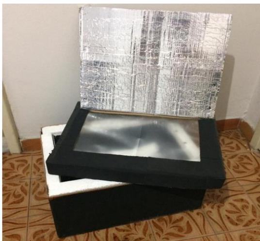
Figura 17: Forno solar de caixa
