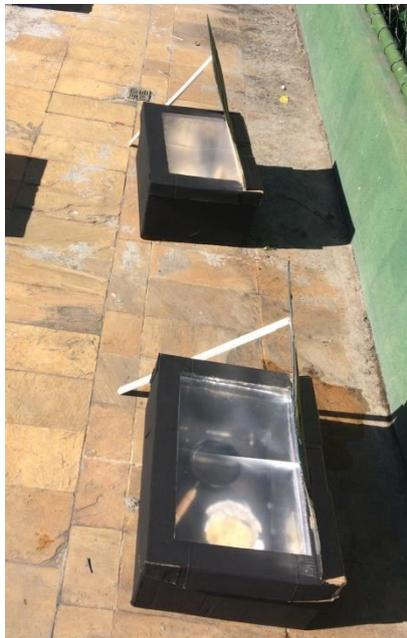
Figura 28: Forno preparando a receita
