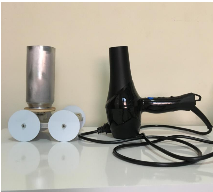
Figura 5.7. O carrinho de Flettner e o secador de cabelo usado no experimento 3.
