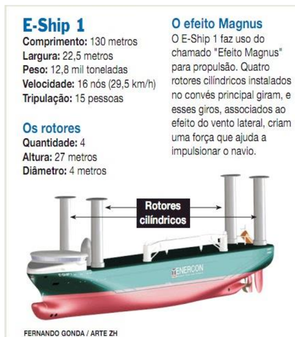
Figura 1.3. Característica do navio E-Ship 1 (Adaptado da fonte: rotaractclubpalmaresdosul.blogspot.com. Acesso em 19 jan. 2019)
