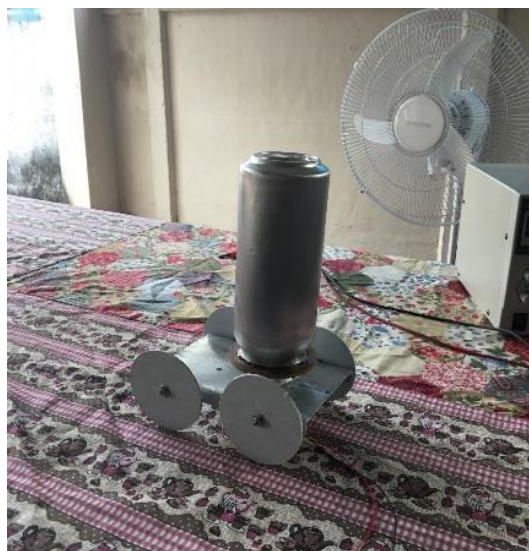
Figura 3.10. Carro de Flettner montado.
