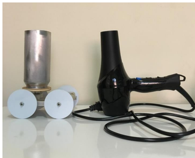
Figura 5.9. O carrinho de Flettner e o secador de cabelo usado no experimento 3.
