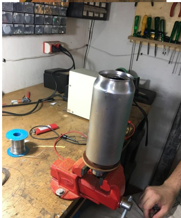
Figura 3.8. Montagem do rotor
