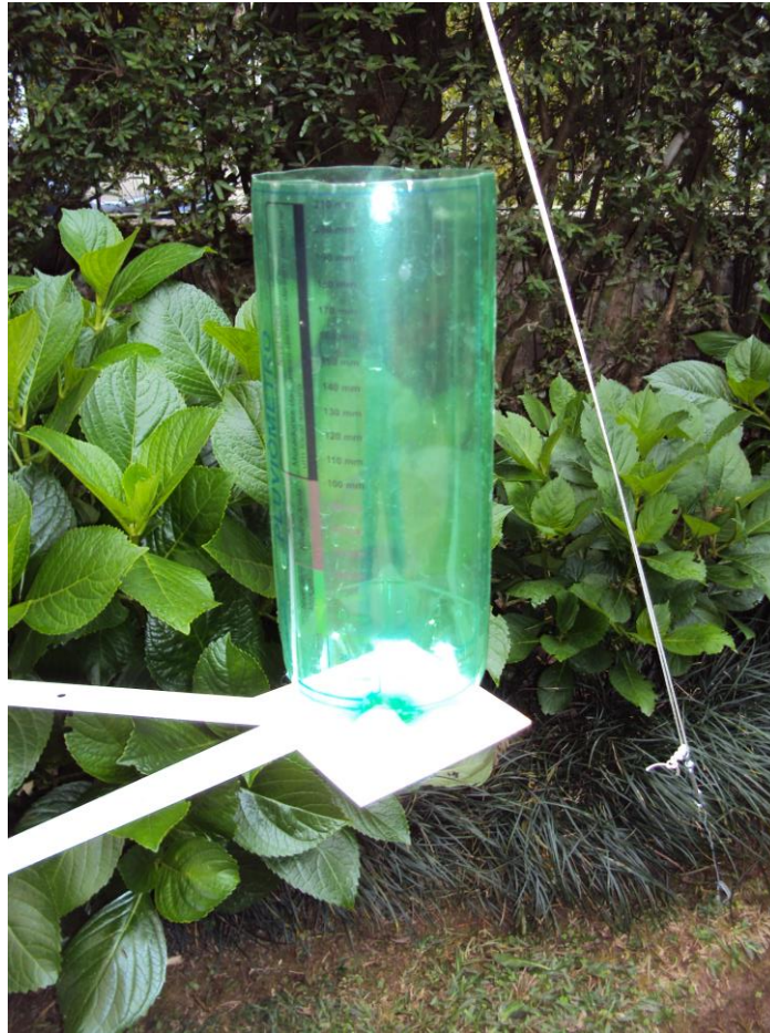
Figura 4.5 – Modelo de pluviômetro PET adotado para a REMC (2019).
