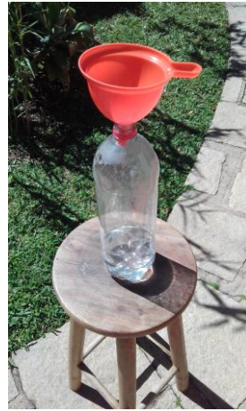
Figura 4.1 – um funil e uma garrafa PET podem ser usados para coletar a água da chuva. Após a chuva, o volume de água coletada na garrafa pode ser usada para comparar com outras chuvas. (Foto: Prof. Helio Salim de Amorim)
