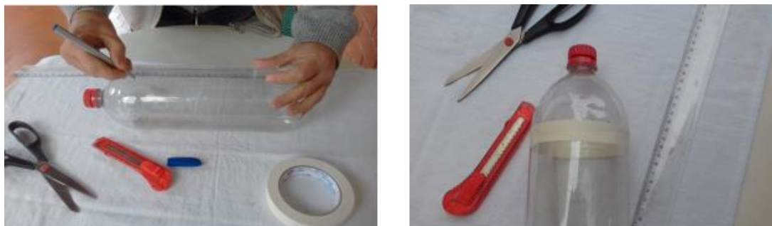
Figura 1.6 – Preparando para o corte. Com uma régua, marcamos a posição do corte em relação a um ressalto de fábrica, na base da garrafa. Marcamos diversos pontos no perímetro de corte. Envolvemos a linha de corte com fita crepe. Usamos um estilete para abrir um pequeno corte na linha. Com a tesoura, fazemos o corte seguindo a fita crepe.
