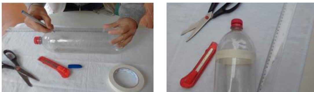
Figura II.2 – Preparando para o corte. Com uma régua, marcamos a posição do corte em relação a um ressalto de fábrica, na base da garrafa. Marcamos diversos pontos no perímetro de corte. Envolvemos a linha de corte com fita crepe. Usamos um estilete para abrir um pequeno corte na linha. Com a tesoura, fazemos o corte seguindo a fita crepe.
