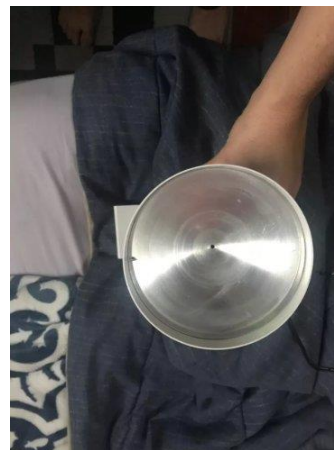
Figura 4.2 – Na fotografia, à esquerda, vemos o copo com o suporte para fixação. Um pequeno nível de bolha é usado para alinhar a boca do copo na horizontal. A água coletada não é acumulada, saindo por furos na base. À direita, vemos o funil. O pequeno furo do funil está sobre o centro do coletor basculante. Neste modelo, cada basculhada verte o correspondente a 2,5 mm de água, já computada como IPV.
