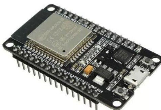
Figura 4.1 – Essa placa é baseada no módulo ESP32 – WROOM 32D que possui um processador central ESP32-D0WD duplo (dual-core) de 32 bits. A placa já vem com uma antena embutida facilitando muito a sua instalação. Para os que desejem conhecer mais detalhes, colocamos a folha de dados técnicos ( datasheet ) como Anexo II.
