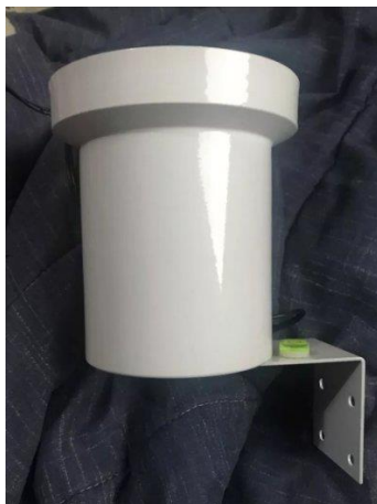
Figura 4.2 – Na fotografia, à esquerda, vemos o copo com o suporte para fixação. Um pequeno nível de bolha é usado para alinhar a boca do copo na horizontal. A água coletada não é acumulada, saindo por furos na base. À direita, vemos o funil. O pequeno furo do funil está sobre o centro do coletor basculante. Neste modelo, cada basculhada verte o correspondente a 2,5 mm de água, já computada como IPV.
