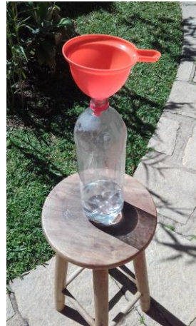
Figura I.1 – um funil e uma garrafa PET podem ser usados para coletar a água da chuva. Após a chuva, o volume de água coletada na garrafa pode ser usada para comparar com outras chuvas. (Foto: Prof. Helio Salim de Amorim)
