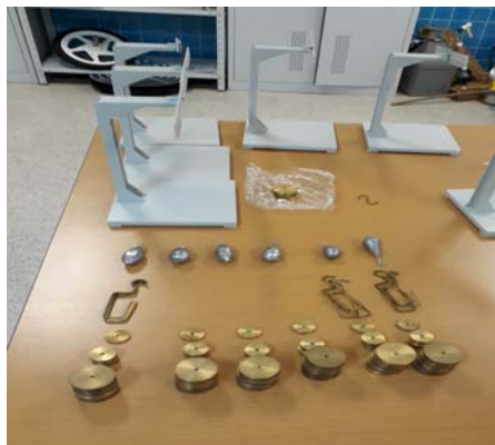
Figura 1. Kit utilizado para construir uma balança de braços.
