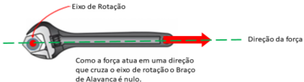
Figura 6. Força que não gera Torque, já que o braço da alavanca é nulo
