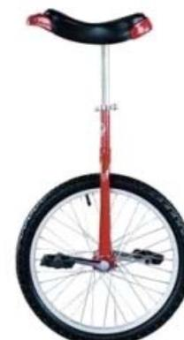
**Figura 6.** Pedais de um monociclo, ligados diretamente à roda.
