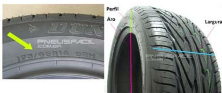
Se o carro do cliente utilizava rodas com aro 13 e pneus 175/65 R13 e ele alterou para pneus 205/60 R16, determine o erro percentual no valor mostrado pelo velocímetro com esta nova configuração.
