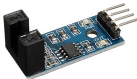
Figura 11: sensor ótico LM393.
