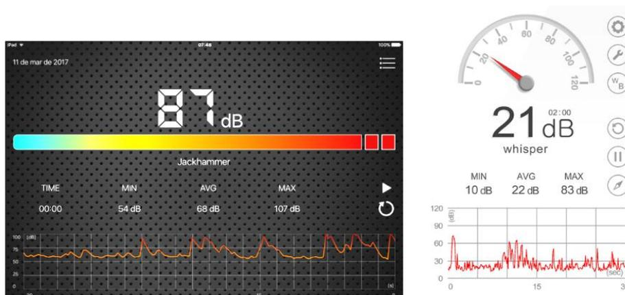
Figura 1: Decibelímetros: Sound Meter, para iPhone (esquerda) e Android (direita).
