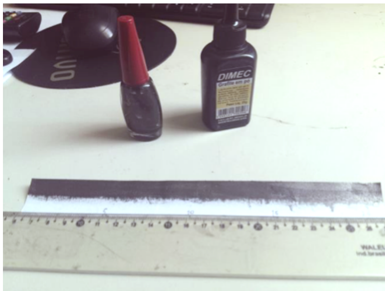
Figura 2. – Uma das fitas de cartolina pintadas com lápis e grafite em pó que foi empregada como resistor nas atividades.
