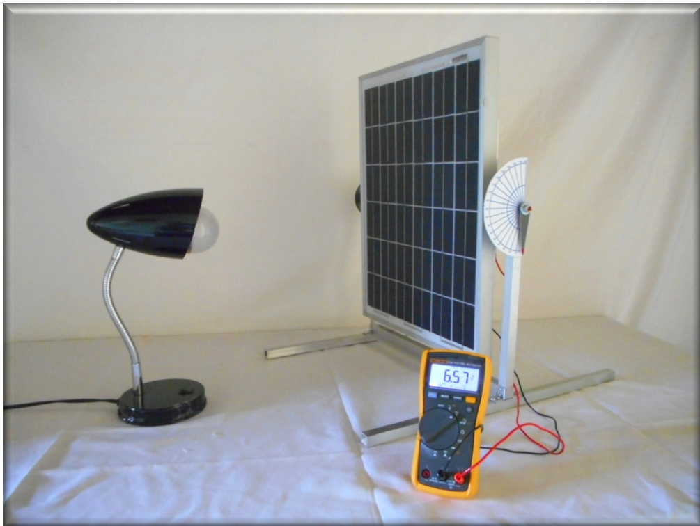
Figura 1 - Posicionamento da luminária em relação ao painel.
