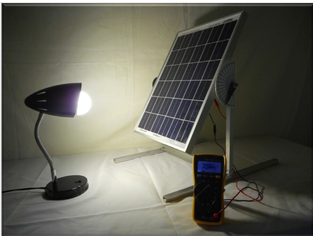
Figura 4 - Medida de tensão DC na inclinação de 30°.
