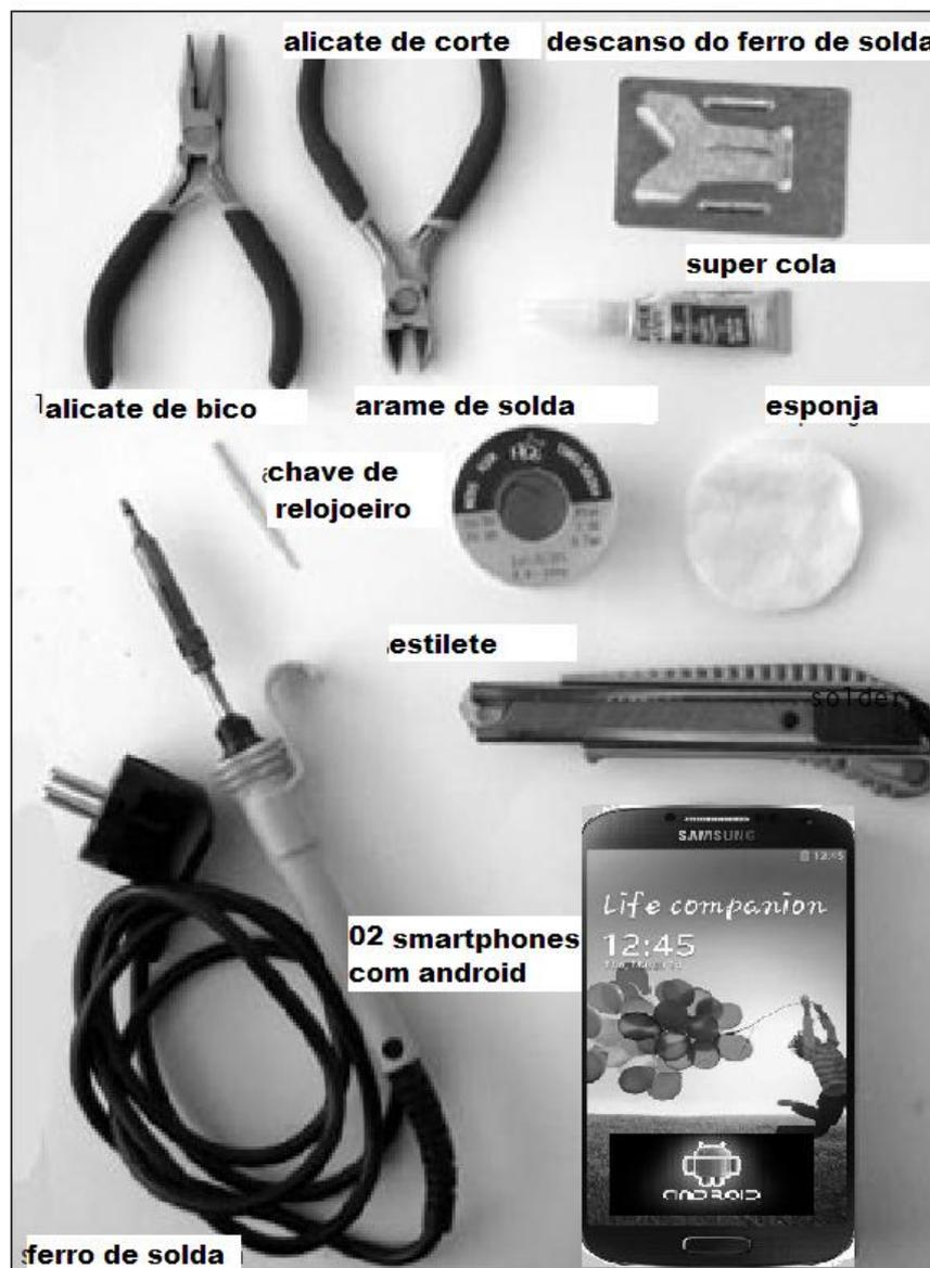
**Figura 2.1.1-1** Ferramentas necessárias para montagem do experimento.
