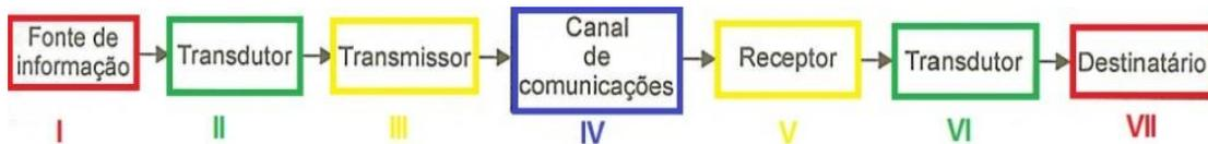
**Fig. 3.2.1** Diagrama em blocos de uma comunicação analógica.
