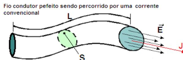
Fig. 3.2.5 Fio de seção reta  $S$  sendo percorrido por uma densidade de corrente  $J$ .
