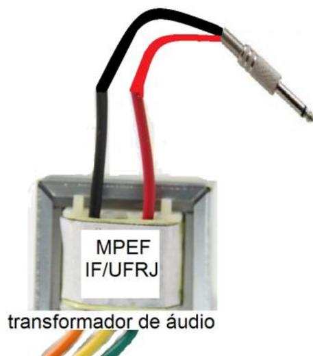
Figura 2.2.2-3 Cabo P2(mono) "3,5mm" ligado ao transformador de áudio
