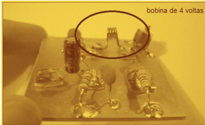
**Figura 2.1.2-11** Soldagem da bobina.
