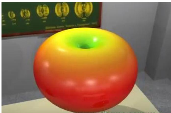
**Figura 3.1-21** Radiação de dipolo infinitesimal.
