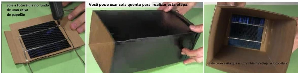
Figura 2.2.3-2 Esquema de caixa protetora fotocélula.
