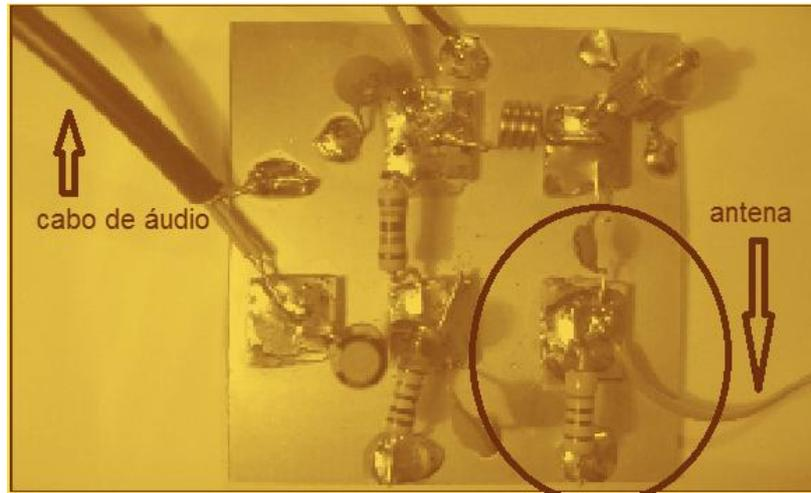
**Figura 2.1.2-14** Soldagem da antena.
