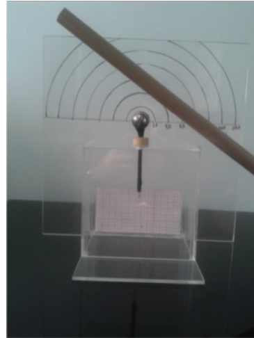
Figura 17. – Bastão posicionado próximo a esfera do bastão. A escala circular impressa na estrutura do eletroscópio é utilizada para determinar a distância até o centro da esfera.
