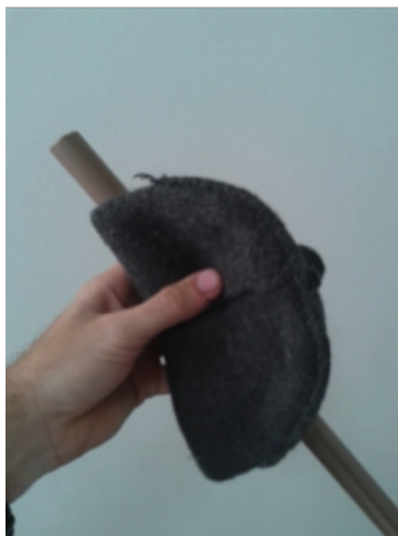
Figura 16. – Bastão atritado com um pano de lã, usado na atividade experimental 2.
