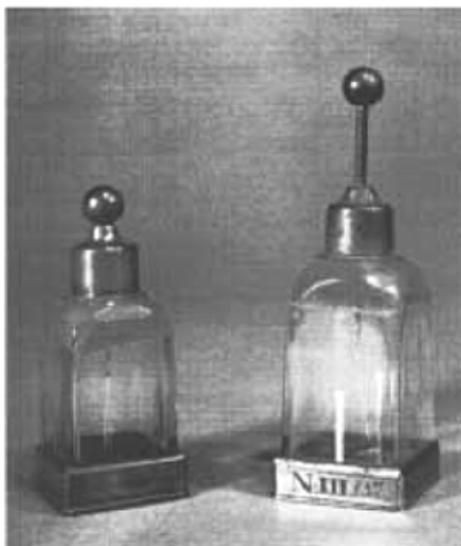
**Figura 10.** – Eletroscópio de folhas de ouro de Bennet (MEDEIROS, 2002).
