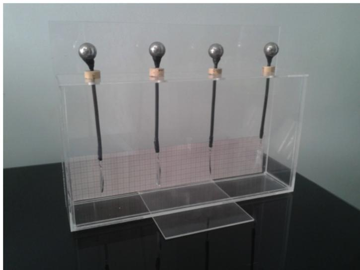
**Figura 51.** – Aparato experimental 1 composto por quatro eletroscópios idênticos, exceto pelas massas ( $m$ ) das folhas que são proporcionais às larguras ( $w$ ).
