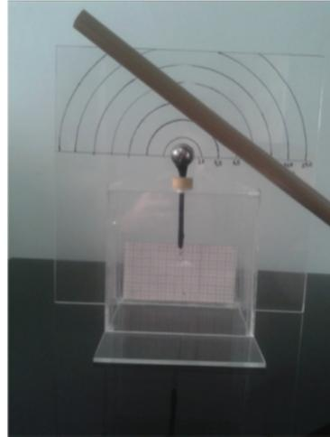
**Figura 27.** – Bastão posicionado próximo a esfera do bastão. A escala circular impressa na estrutura do eletroscópio é utilizada para determinar a distância até o centro da esfera.
