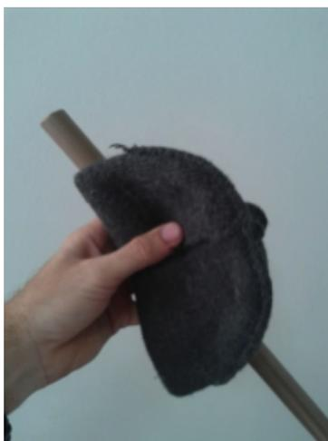
**Figura 26.** – Bastão atritado com um pano de lã, usado na atividade experimental 2.
