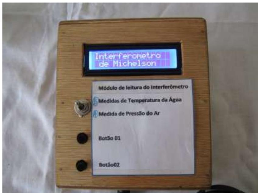
Figura 4, Modulo Arduino acondicionado em uma caixa.
