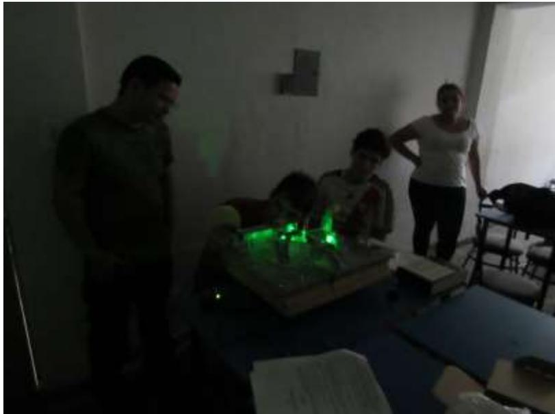
**Figura 34. Alunos do técnico calibrando o interferômetro.**
