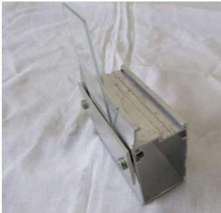
**Figura 101. Suporte da lâmina de microscópio. Vista da lateral esquerda.**
