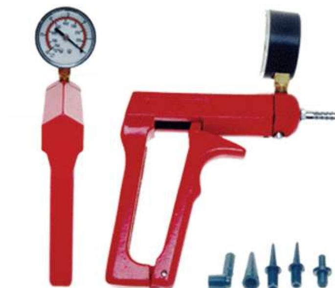
**Figura 20. Bomba de vácuo usada em oficinas mecânicas**
