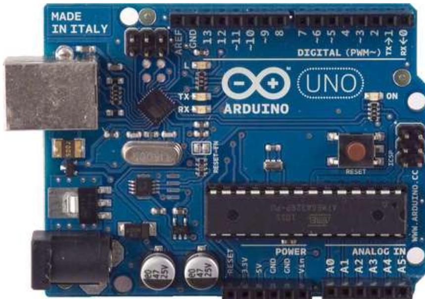
Figura 23. Exemplo do Arduino modelo UNO.
