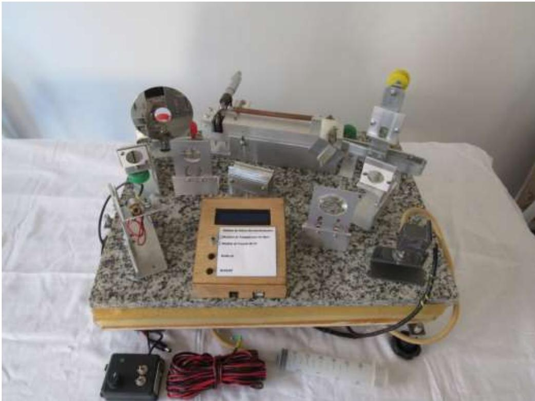
**Figura 92. Interferômetro completo. 1**
