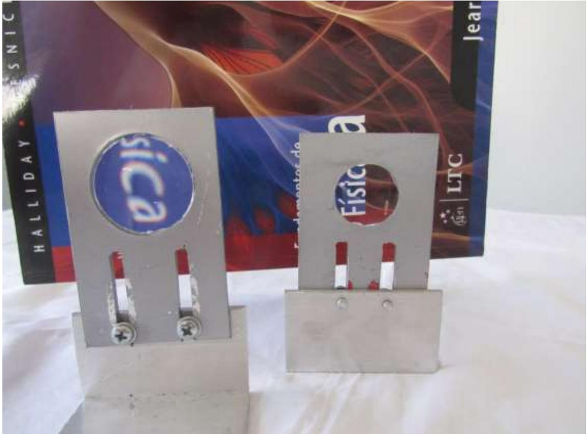
Figura 106. Suporte da lente. A direita lente côncava. A esquerda lente convexa.
