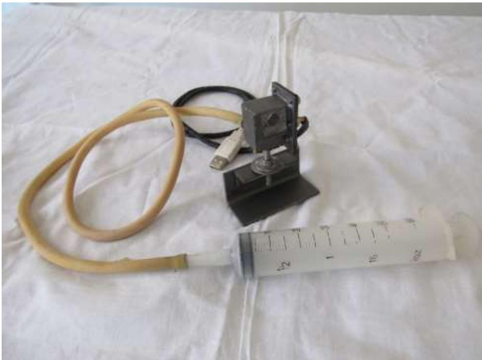
Figura 108. Célula de Ar, destaque para a janela óptica feita com lâmina de microscópio.
