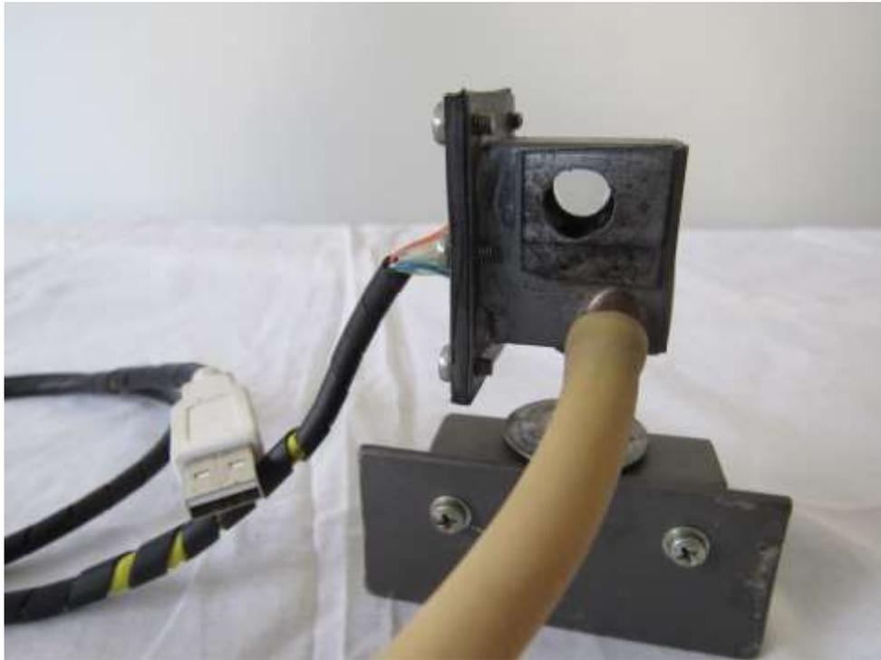
Figura 107. Célula de Ar, com seringa para vácuo e mangueira de borracha.
