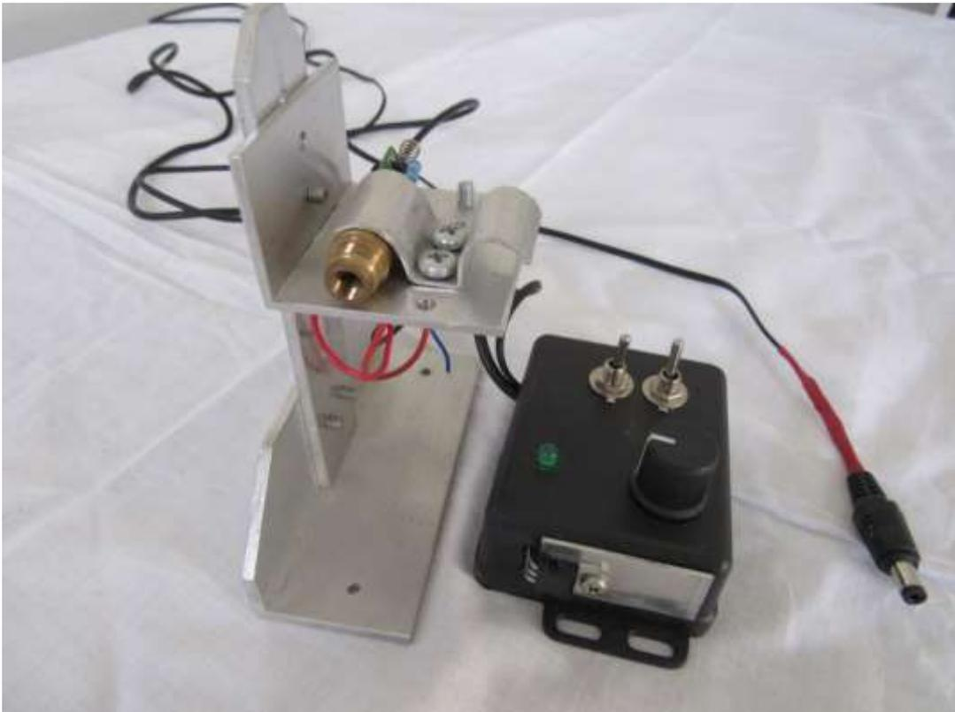
**Figura 98. Suporte do laser com circuito regulador de tensão. Vista frontal.**
