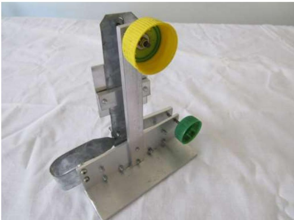
Figura 103. Suporte do espelho de maquina fotocopidora. Vista de trás.
