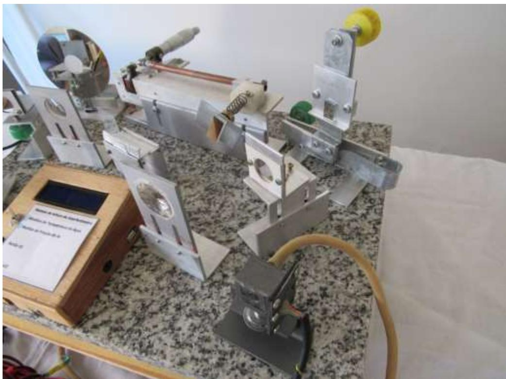
**Figura 93. Interferômetro completo. 2**
