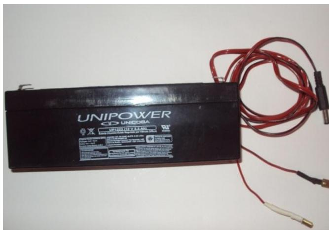
**Figura 23** - Bateria selada e cabo de alimentação utilizados no projeto.
