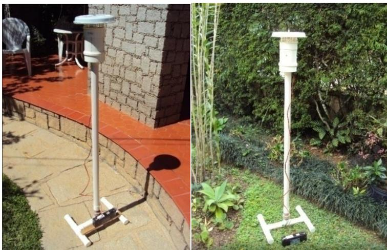
**Figura 24** - Fotografia dos dois mini abrigos meteorológicos.
