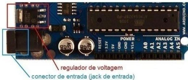
**Figura 22** - Regulador de voltagem ao lado do Jack de entrada para fontes externas
