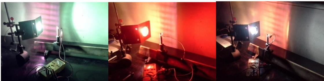
*Fig18 – Montagem para absorção do LED, com o uso de filtro de celofane. O filtro foi posto em uma base para ficar fixo. À esquerda a aquisição dos dados sendo feita com o filtro celofane verde, no meio está sendo utilizado o filtro celofane vermelho e à direita o filtro celofane azul.*
