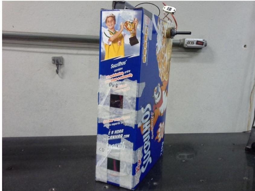
*Fig. 8 – Do lado oposto à fenda fizemos dois furos retangulares, um no meio da caixa e outro na parte de baixo. No furo retangular do meio foi fixado o DVD. No furo abaixo foi posto o CD (para fazer a fixação foi utilizada fita crepe). O CD e o DVD foram cortados e retirados à película metálica.*
