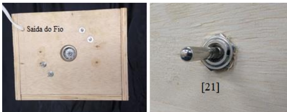
Figura A.44: Mostra a saída do fio e o interruptor preso do lado de fora da caixa.
