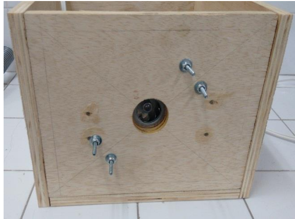
Figura A.39: Mostra a parte da frente do compensado com o motor preso.
