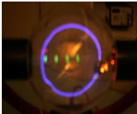
Figura E.4: **Feixe de elétrons.** (Mendes da Silva *et al.*). O feixe forma um círculo, com velocidade perpendicular ao campo magnético.
