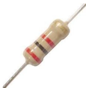
Figura 3.7 – Um típico de resistor de carvão usado em aplicações de eletrônica. As barras coloridas servem para indicar o valor da resistência através de uma convenção apresentada no Anexo II.
