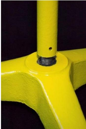
**Figura 11** Detalhe da fixação da haste à base.
