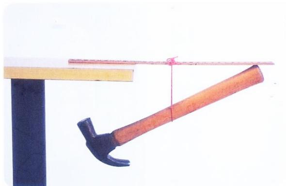
**Figura 2.29** Sistema martelo-haste em equilíbrio estático apoiada na extremidade de uma mesa horizontal como exemplo lúdico do conceito de centro de massa. Fonte: *Ramalho [6]*.
