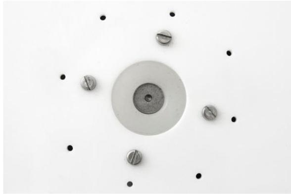
**Figura 3.5** Detalhe do eixo e da base acrílica na qual o rolamento é fixado. Os parafusos prendem o disco à base acrílica.
