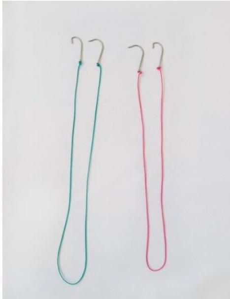
**Figura 3.10** Linha de artesanato e anzol de pesca. (utilizados para: suspensão dos pesos em uma extremidade e fixação ao disco acrílico na outra).
