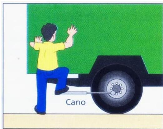
**Figura 2.3** Uso de um cano como auxílio no desparafusar duma roda como exemplo de aplicação do conceito de torque. Fonte: *Helou* [3].
