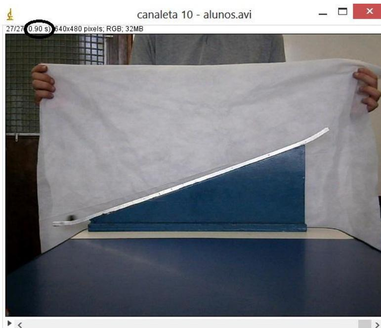
**Figura 4.40.** A esfera na parte final da canaleta quando  $t = 0,90s$ .
