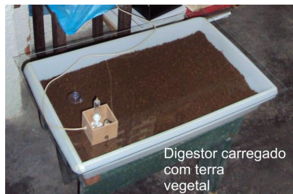
Figura 4.1 – Um dos modelos de digestor carregado com terra vegetal para observação da produção de gás metano.
