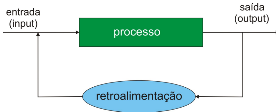
Figura 3.1 – Representação esquemática do mecanismo de retroalimentação.
