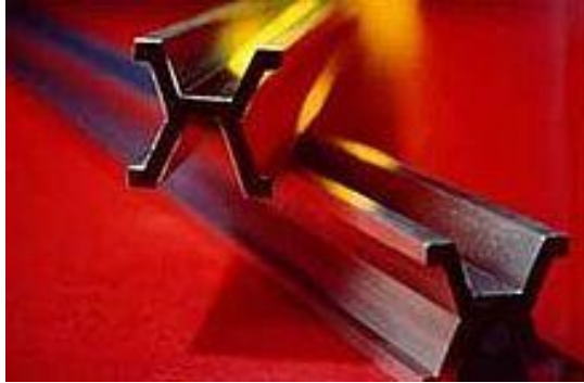
FIGURA 9: Barra de platina-irídio utilizada como protótipo do metro de 1889 a 1960.
