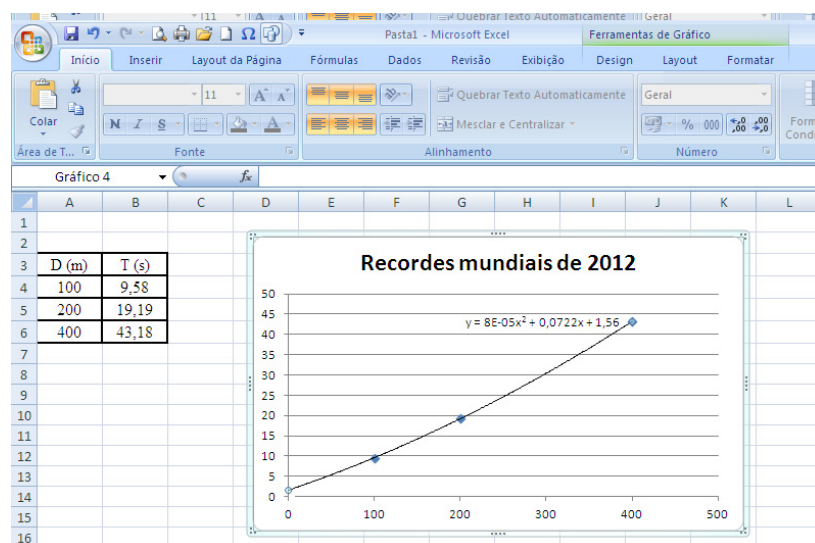
Figura 5: Tela com a tabela, o gráfico e a função do mesmo, com os respectivos coeficientes.
