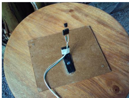
Figura 3.12 - Sensor de temperatura fixado em um pedestal de plástico no centro da maquete.
