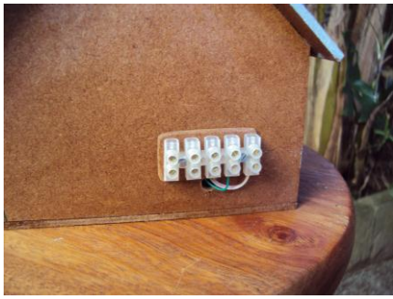
Figura 3.14 – Barra de conectores fixada às maquetes.
