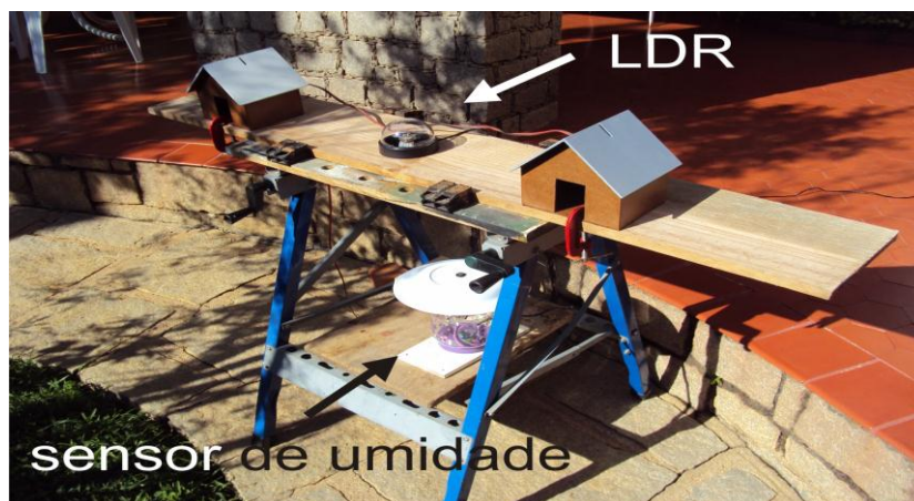
Figura 3.16 – Montagem experimental de testes para o estudo da proposta “Pinte o seu Telhado de Branco”. Na foto vemos as duas maquetes usadas, uma com o telhado pintado de branco e outra pintada de cinza. Entre as duas maquetes está o resistor LDR para medir a incidência de luz e abaixo o sensor de umidade.
