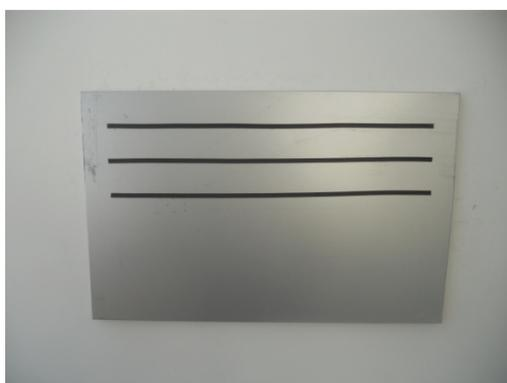
Figura A.10: Quadro magnético com linhas retas paralelas feitas de ímãs em forma de tiras, para o estudo da propagação retilínea da luz ou estudo da linha reta em Matemática.
