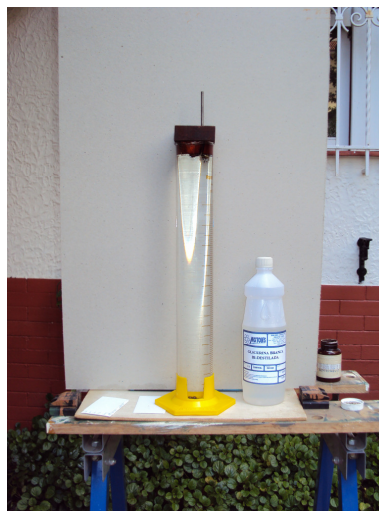
Figura 21 - Sistema experimental para queda de esferas em diferentes meios fluidos.
