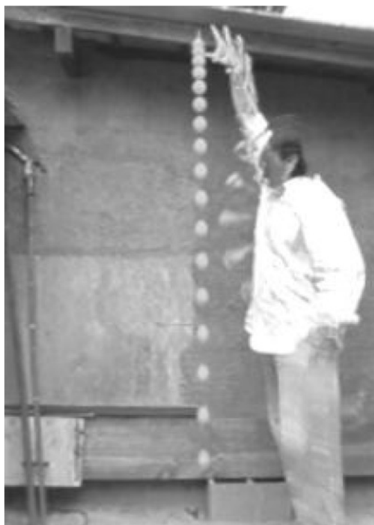
Fig. 1a – Fotografia estroboscópica do movimento de queda livre de uma bola de plástico (massa = 35 g e diâmetro = 5,0 cm). A distância percorrida pela bola na fotografia foi de aproximadamente 2,0 m.
