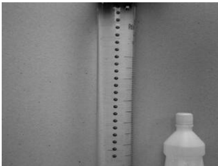
Figura 26 - Fotografia estroboscópica de uma esfera caindo através da glicerina.
