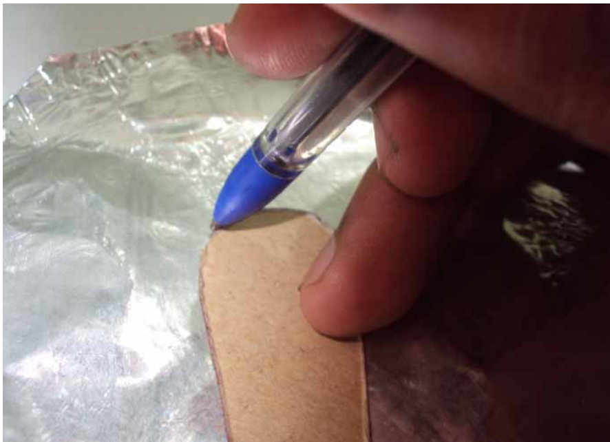
Figura A.31 – Usando o modelo feito na cartolina para fazer os setores metálicos.
