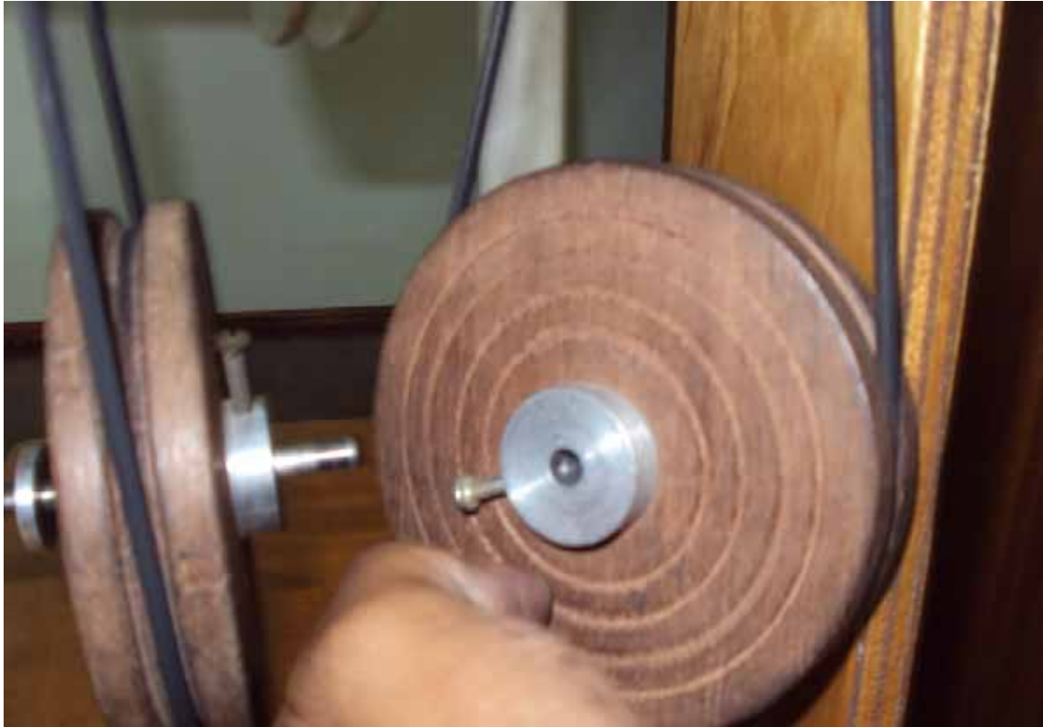
Figura A.64 – Iniciando a torção do o-ring mais próximo da coluna de PVC.
