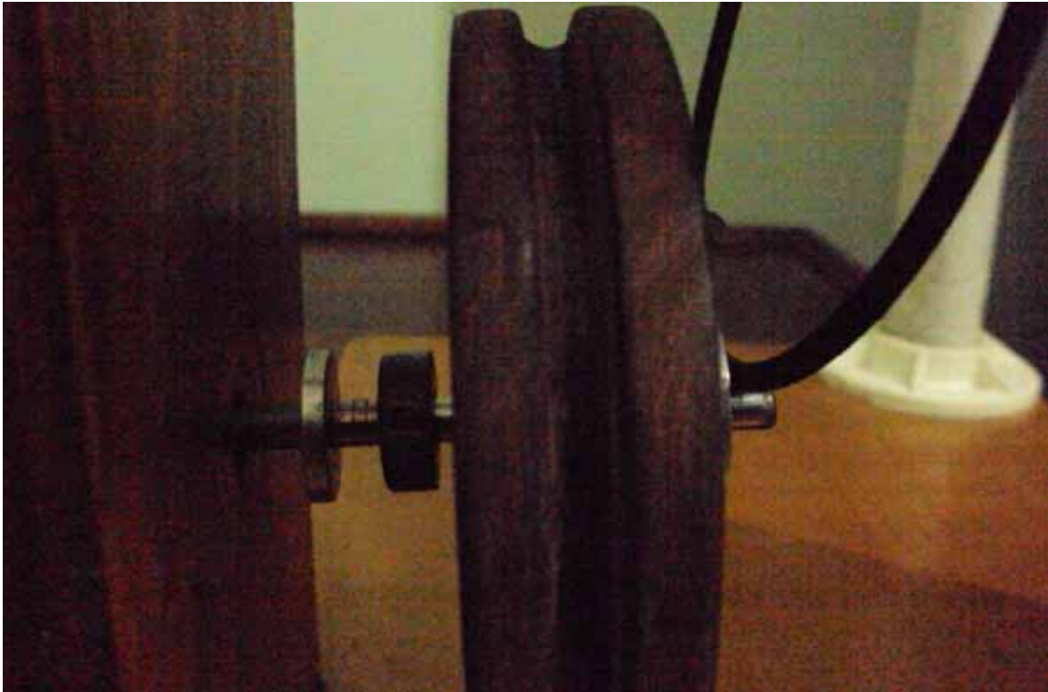
Figura A.62 – Colocando a polia maior na manivela.
