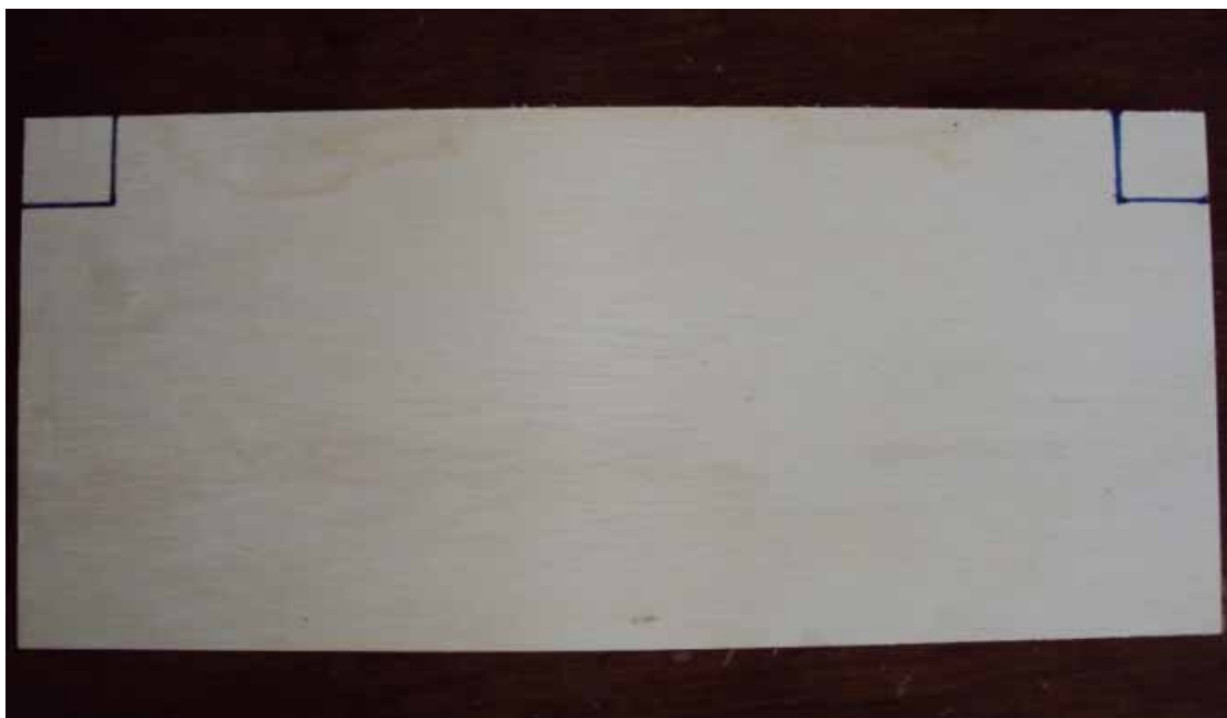
Figura A.20 – Nos pontos onde ocorre o encontro das linhas azuis devem ser colocado a broca que guia a serra copo.
