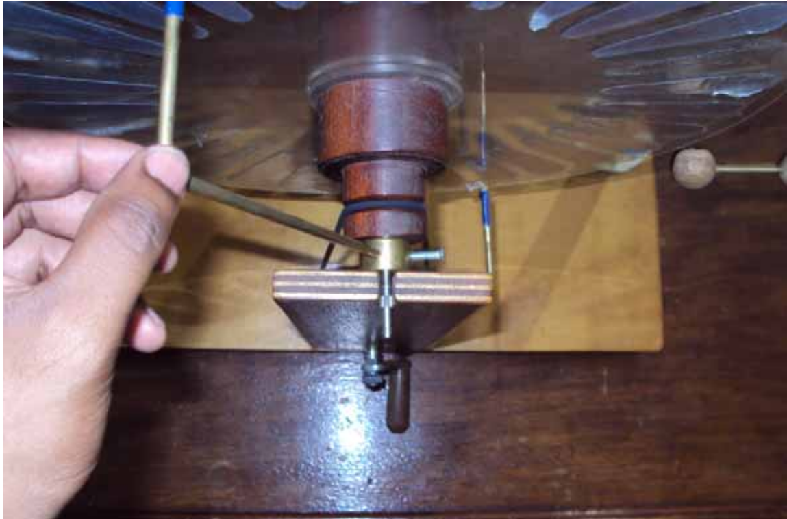
Figura A.69 – Posicionando o neutralizador mais afastado das colunas de PVC.
