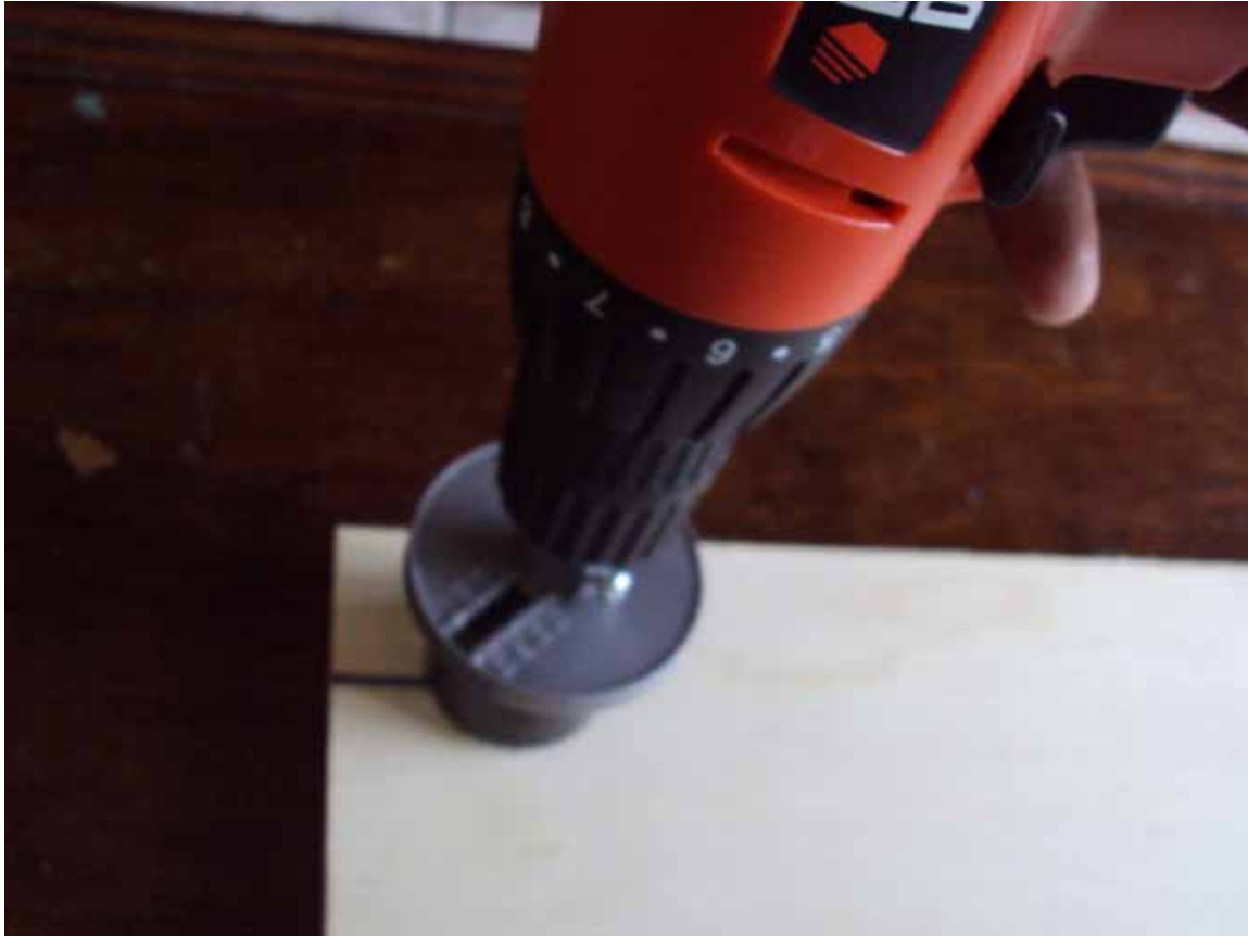
Figura A.21 – Furando com a serra copo.
