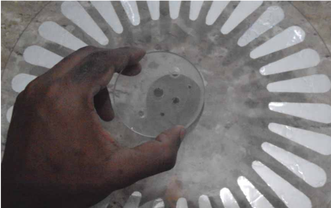
Figura A.33 – Preparando o alinhamento dos furos do disco de acrílico menor com o disco de acrílico maior. Repare que os furos da polia menor também estão alinhados com os furos do disco maior. Os furo da polia para a inserção do parafuso deve ser feito com broca 5/32 e posteriormente deve passar os machos conforme instruções no final desse apêndice.
