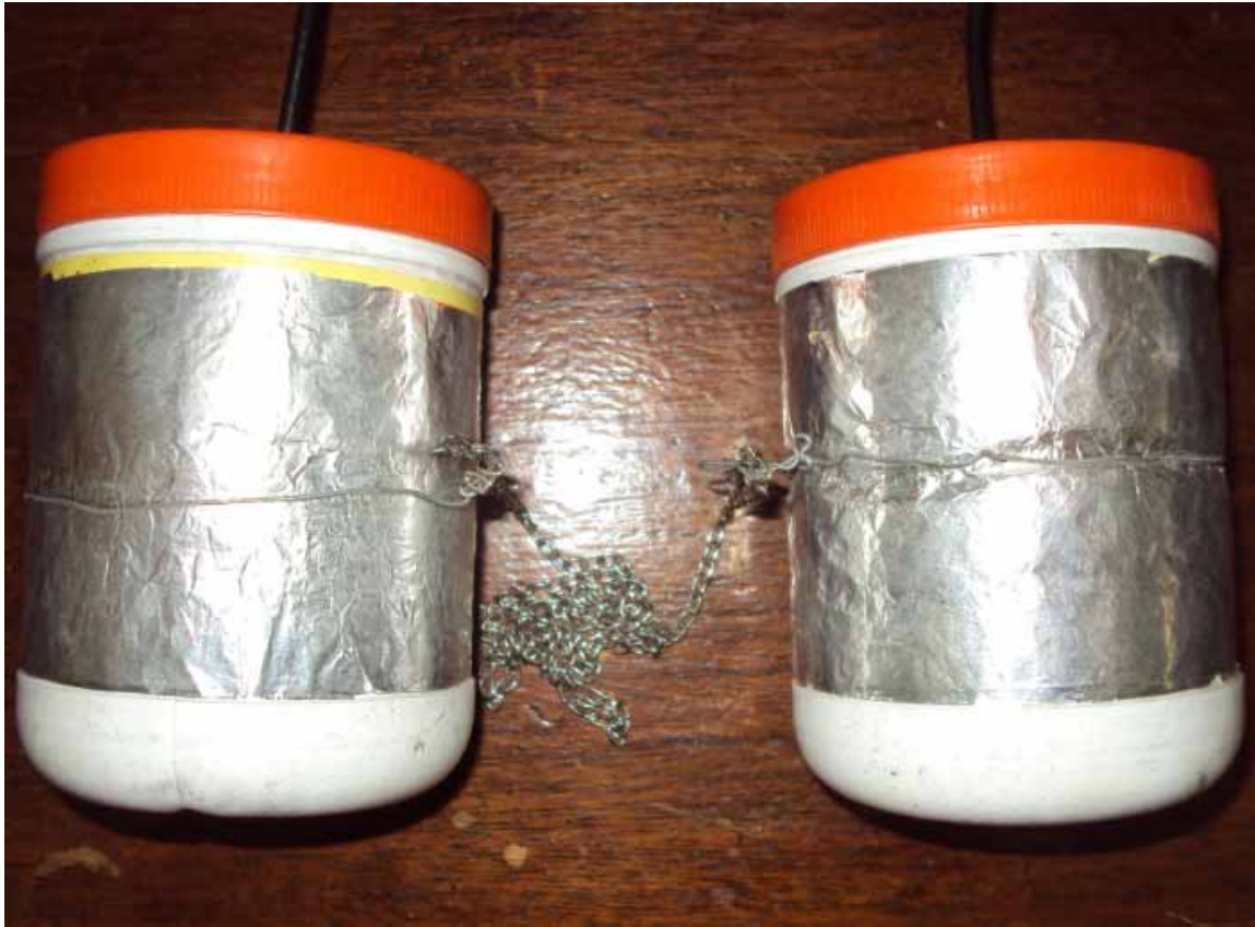
Figura A.79 – Interligando as duas tiras externas com corrente metálica.
