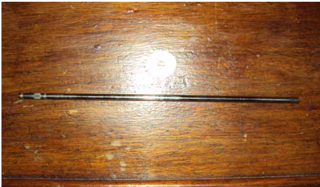
Figura A.5 - Um eixo de impressora de 6mm de diâmetro e 25 cm de comprimento e 1 cilindro de papelão de 4 cm de diâmetro com furo no centro da base de 7 mm de diâmetro. Lembrando que são necessários 2 eixos para a montagem.
