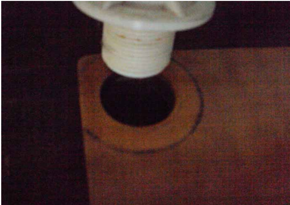
Figura A.45 – Colocando a coluna de PVC.
