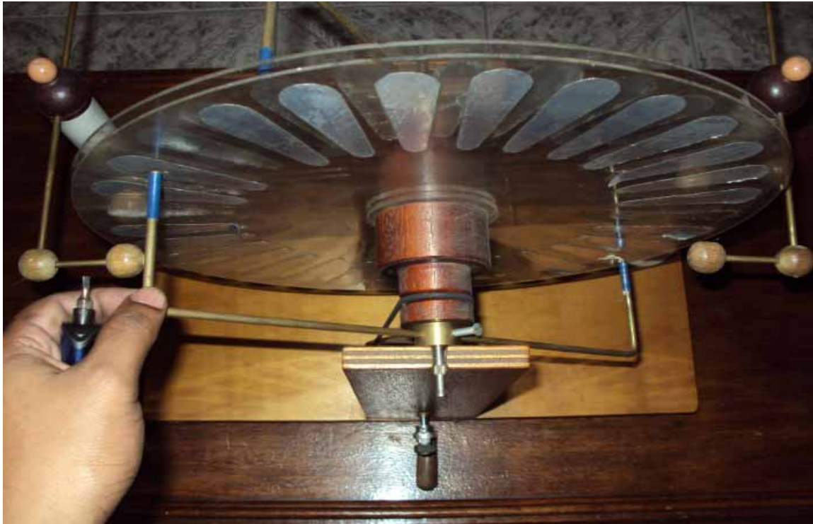
Figura A.70 – Neutralizador mais afastado das colunas de PVC na posição correta.
