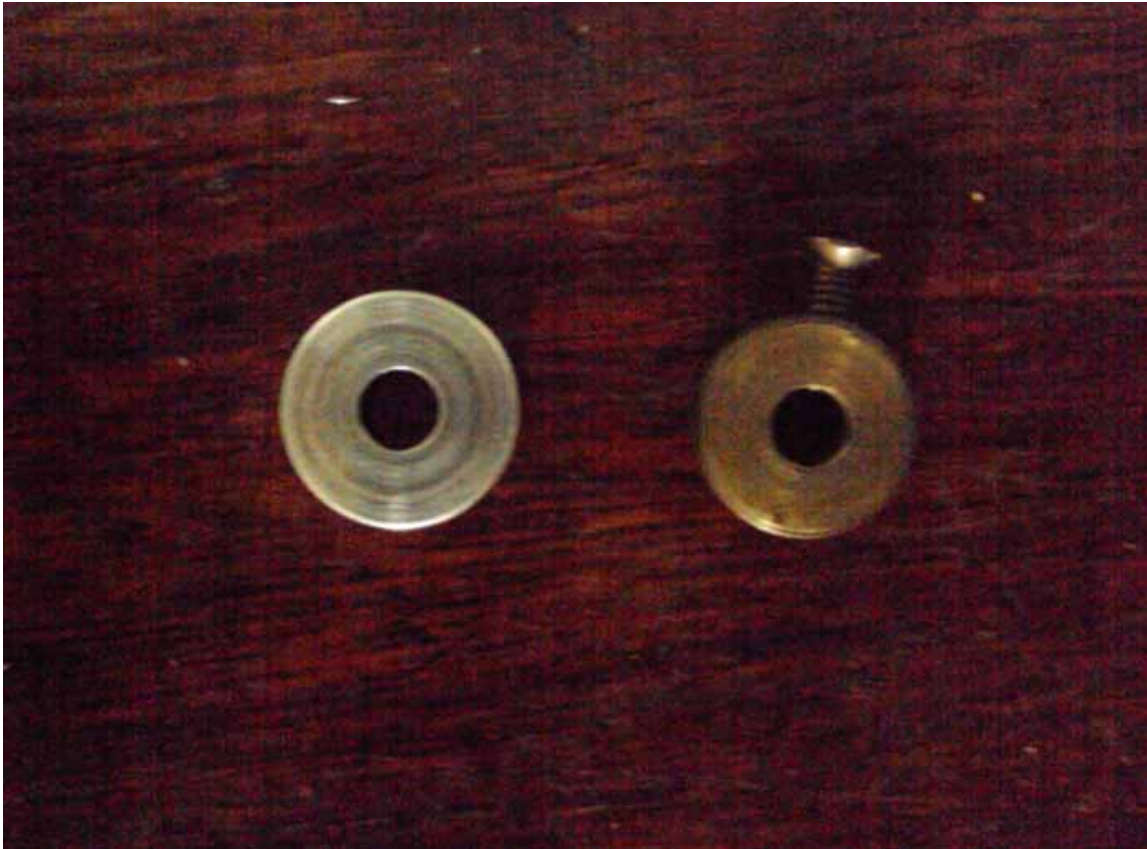
Figura A.3 - Cilindros reto de latão com base de 1 polegada de diâmetro e 1 cm de altura (essas peças serão colocadas no eixo de baixo (um dos cilindros a disposição dos autores é de alumínio)).
