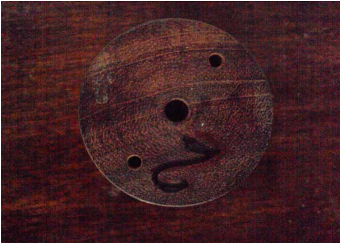
Figura A.11 - Polia pequena com furo central de 7mm e com dois furos que devem estar alinhados com os dois furos dos discos de acrílico menor.
