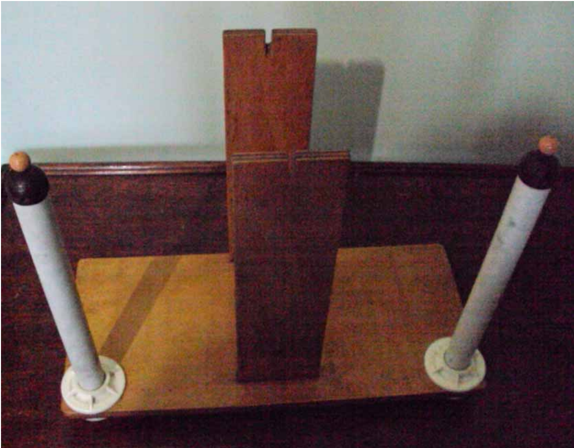
Figura A.47 – Base da máquina com as colunas de PVC e compensado de 10 cm de largura.
