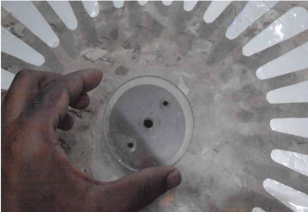
Figura A.34 – Alinhando os furos do disco de acrílico menor, com os furos do disco de acrílico maior e também com os furos da polia.
