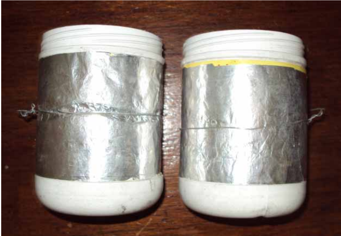
Figura A.77 – Folha de papel alumínio da parte externa da garrafa de Leyden envolvida por arame.
