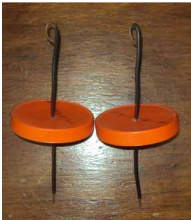
Figura A.76 – Estrutura da tampa da garrafa de Leyden..
