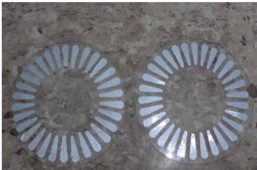
Figura A.32 – Setores metálicos colados no disco maior de acrílico.
