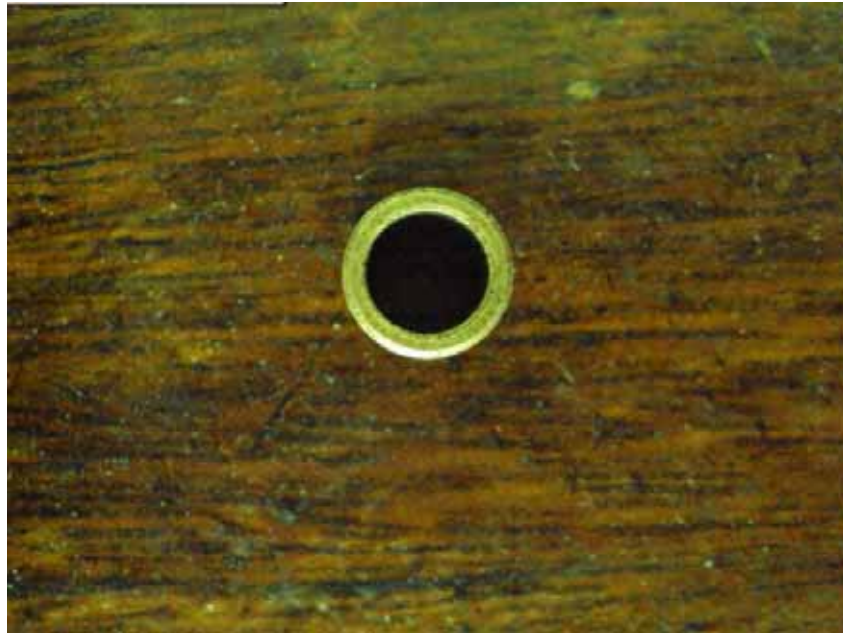
Figura A.6 - Bucha stander comprada em lojas especializadas em peças de arranque e alternador, de raio interno 7 mm.
