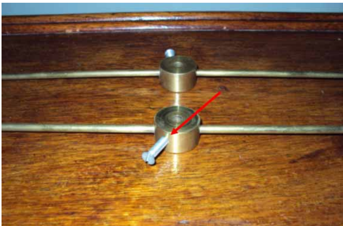
Figura A.18 - Parafuso inserido num furo com rosca feita com o uso dos machos.
