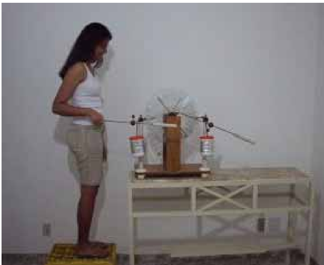
Figura A.84 – Estudante em cima da caixa de refrigerante e em contato com um dos terminais da máquina descarregada.
