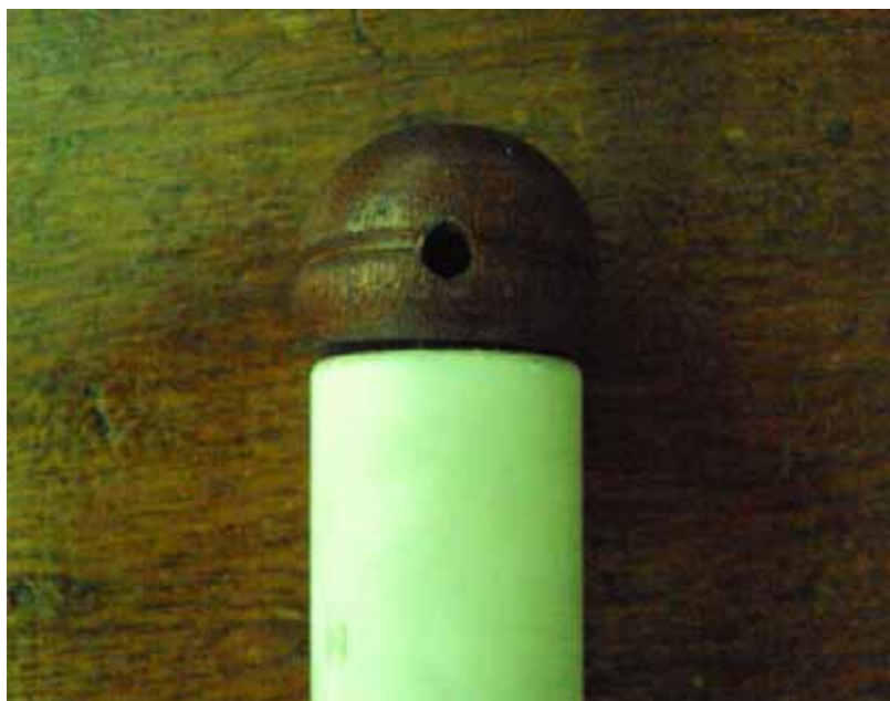
Figura A.41 – Furo no puxador de armário por onde deve passar o latão de 3/16. Neste furo não deve ser feito rosca.
