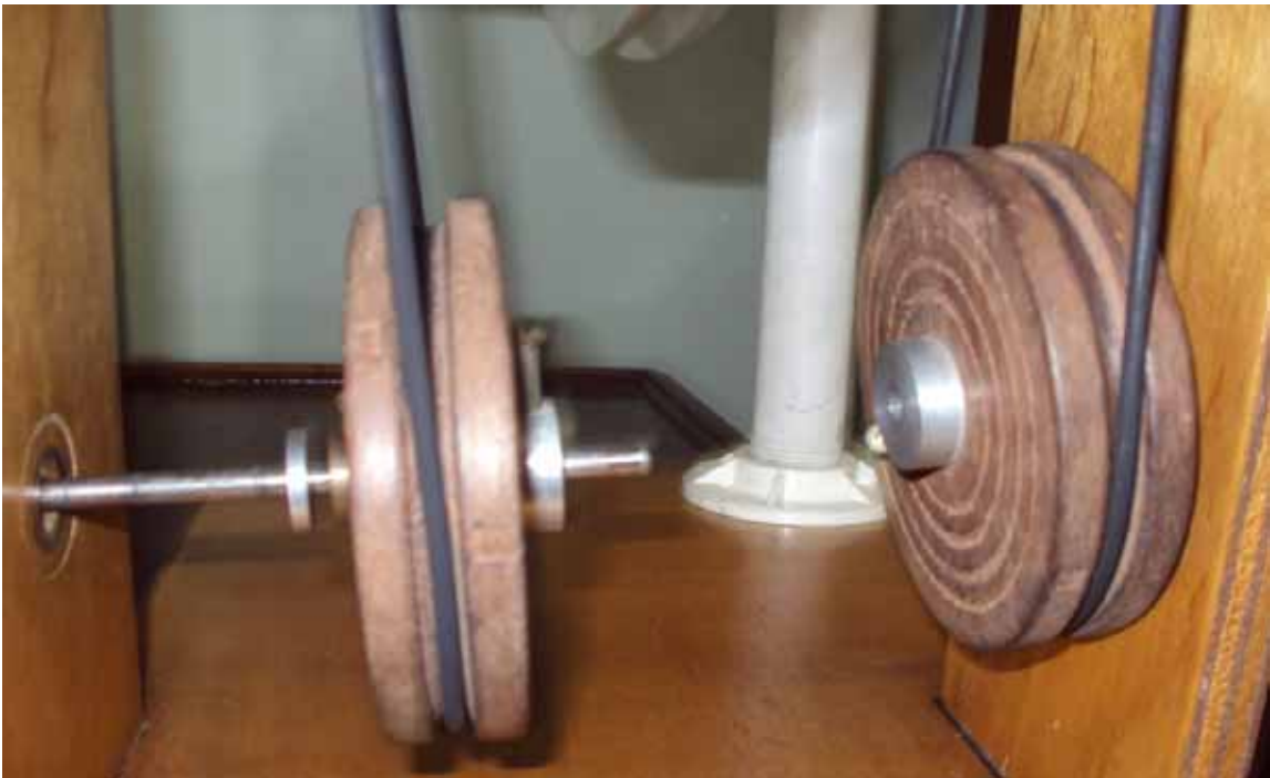
Figura A.63 – Colocando a segunda polia maior no eixo da manivela.
