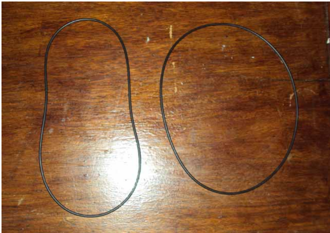
Figura A.4 - O-rings de aproximadamente 3 mm de espessura.
