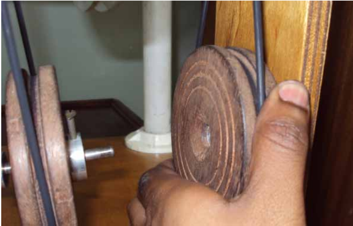
Figura A.66 – Torção completa do o-ring mais próximo das colunas de PVC.
