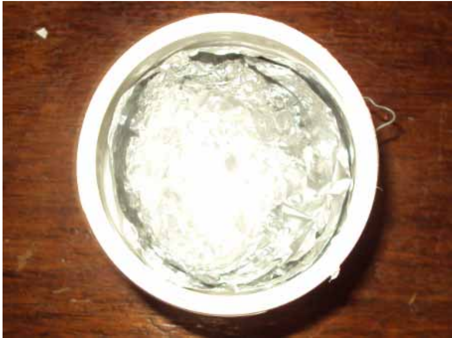
Figura A.78 – Vista de cima do pote de achocolatado com destaque para as folhas de alumínio coladas na base interna e na parede interna.
