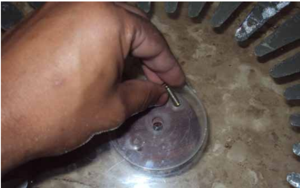
Figura A.35 – Colocando os parafusos nos discos e na polia menor.
