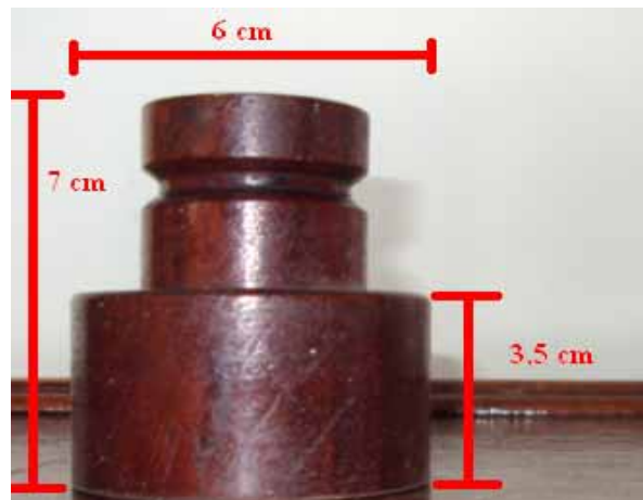
Figura A.9 - Polia pequena com furo central de 7 mm. Nesta figura, damos destaque para o cilindro de diâmetro de 6 cm.
