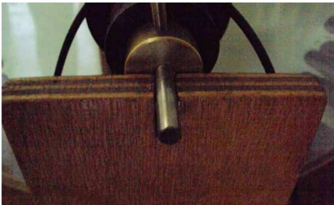
Figura A.56 – Destaque do eixo superior encaixado na fenda do compensado de 10 cm de largura
