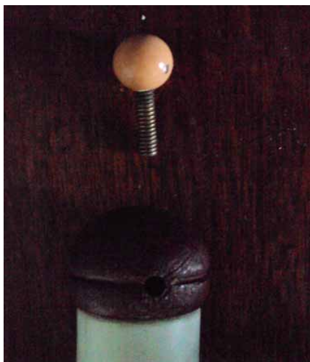
Figura A.42 – Inserindo a peça de fixação dos coletores. Lembrando que pode ser substituída por um parafuso de 3/16.
