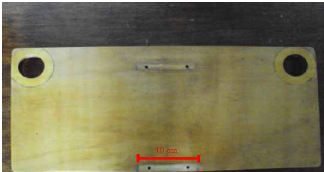
Figura A.23 – Destaque para o retângulo de comprimento 10 cm cujo ponto médio do comprimento coincide com o ponto médio da borda de maior comprimento da base. Nesta foto também ilustra os furos com a serra copo.
