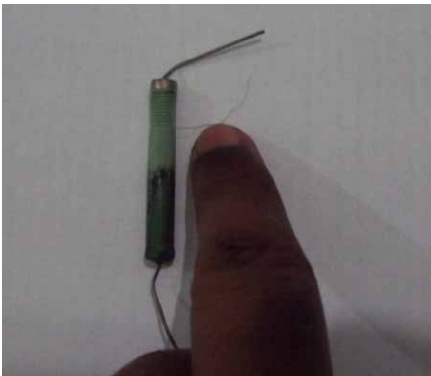
Figura A.12 - Resistor de fio. Após a raspagem da camada verde os fios de níquel cromo estarão acessíveis podendo ser cortados e colocados posteriormente nos neutralizadores e nos coletores.
