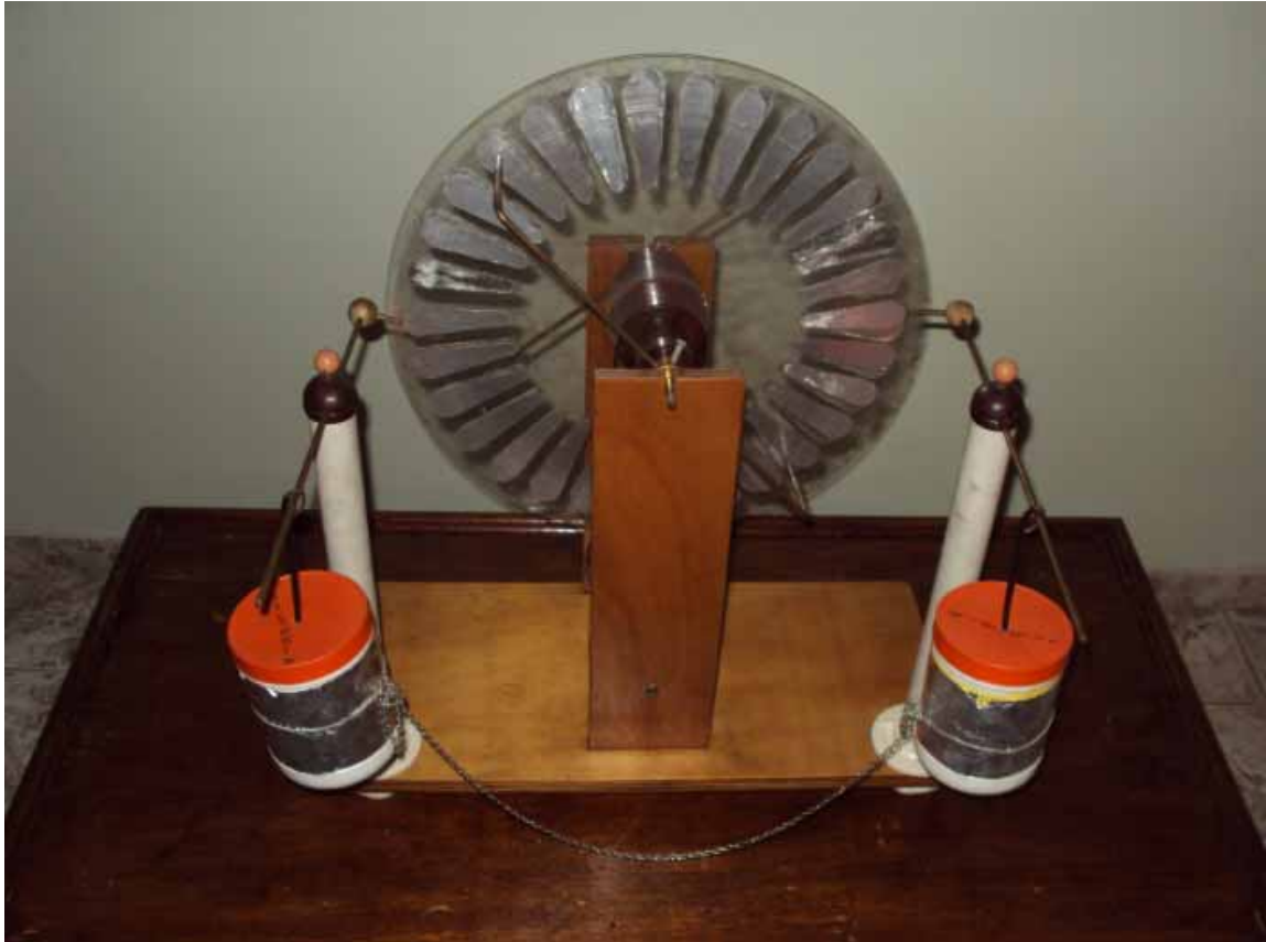
Figura A.80 – Acoplando as garrafas de Leyden na máquina.
