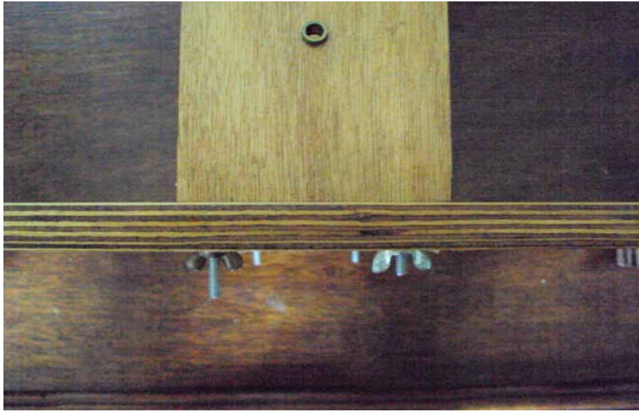
Figura A.29 – Destaque para as borboletas nas barras enroscadas.
