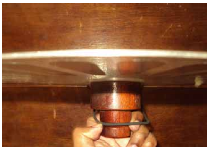
Figura A.49 – Preparando um disco maior com um o-ring.
