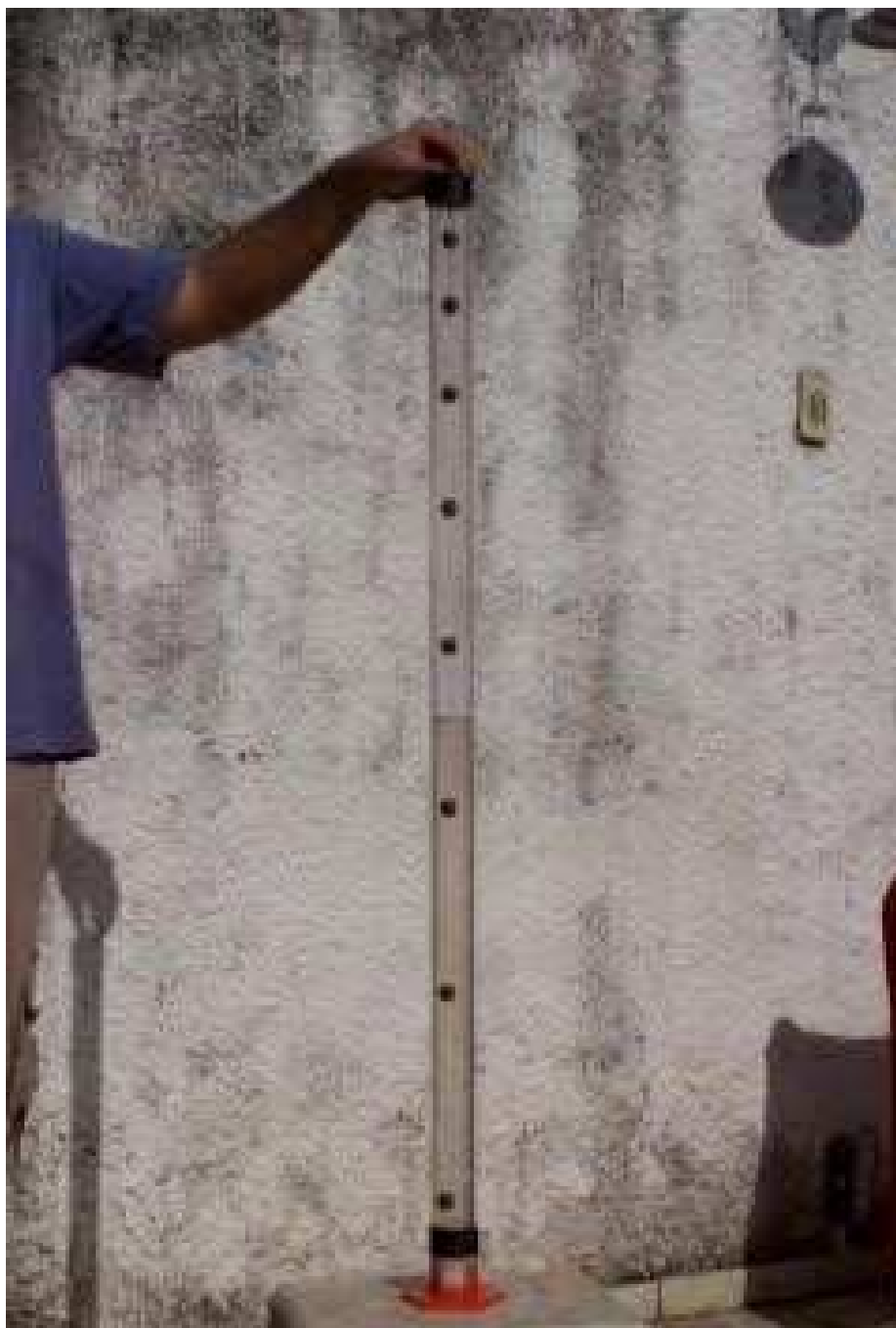
Figura 15: Esfera em queda livre dentro de um tubo de acrílico com 180 cm.
