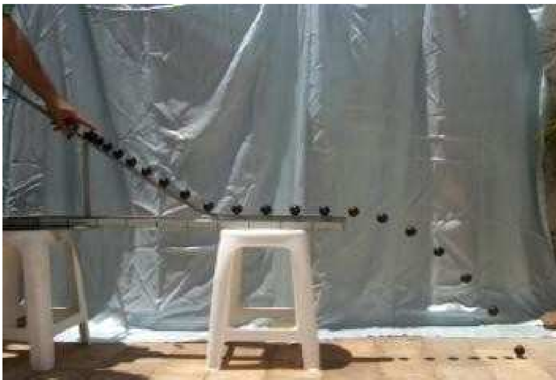
Figura 18: Fotografia estroboscópica digital de uma esfera movendo-se inicialmente sobre uma canaleta inclinada, depois na horizontal e termina em queda livre.
