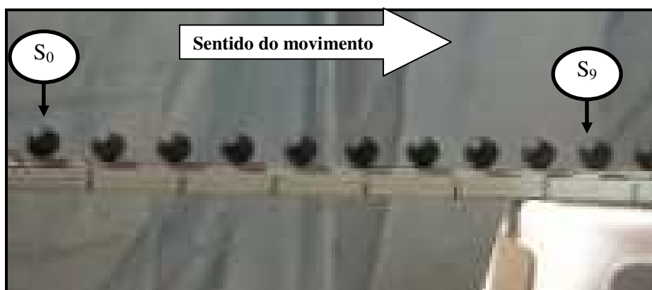
Figura 1: Fotografia estroboscópica digital de uma esfera que se move sobre uma canaleta horizontal. Frequência de filmagem: 25 fotogramas por segundo.
