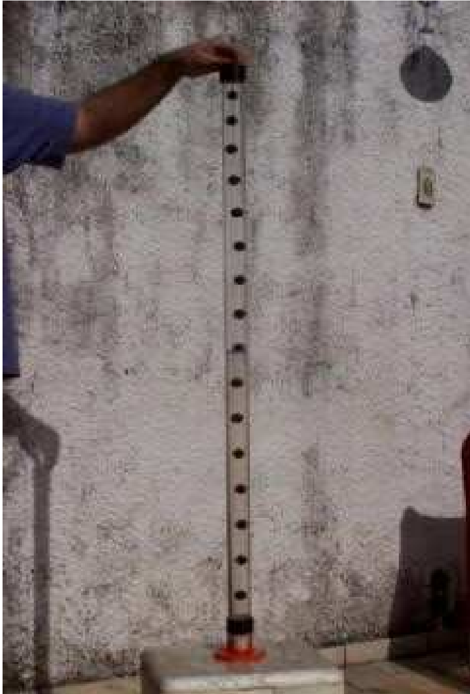
Figura 14: Esfera em queda dentro de um tubo de acrílico com 180 cm cheio d'água.
